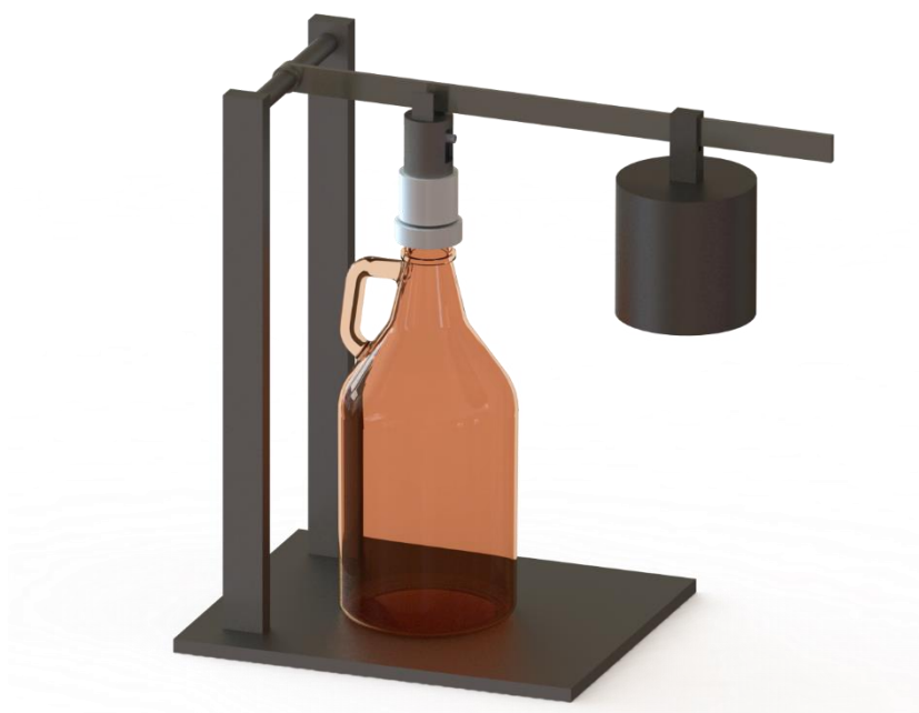
Figura 25 - Esquema de montagem do experimento para medir a força necessária para vedar o growler .
