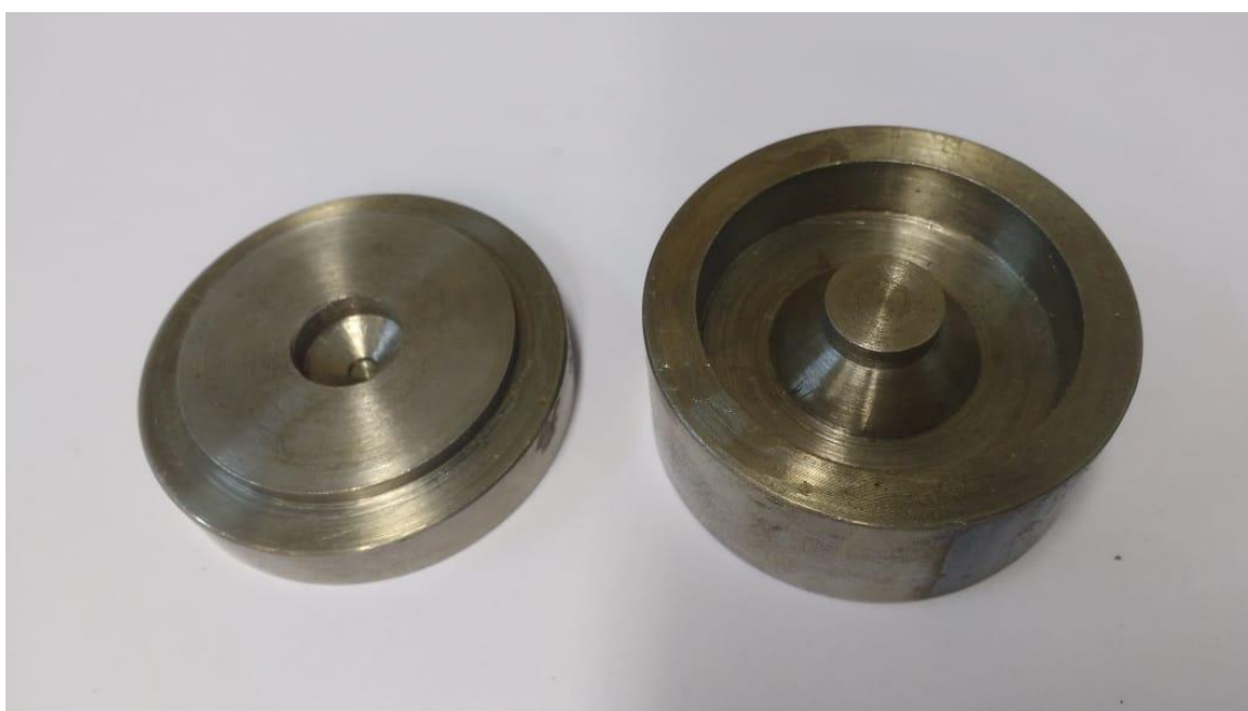
Figura 30 - Molde para fabricação da vedação.
