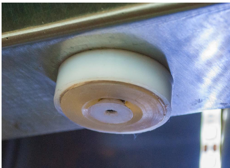
Figura 31 - Vedação já fixada ao acoplador.
