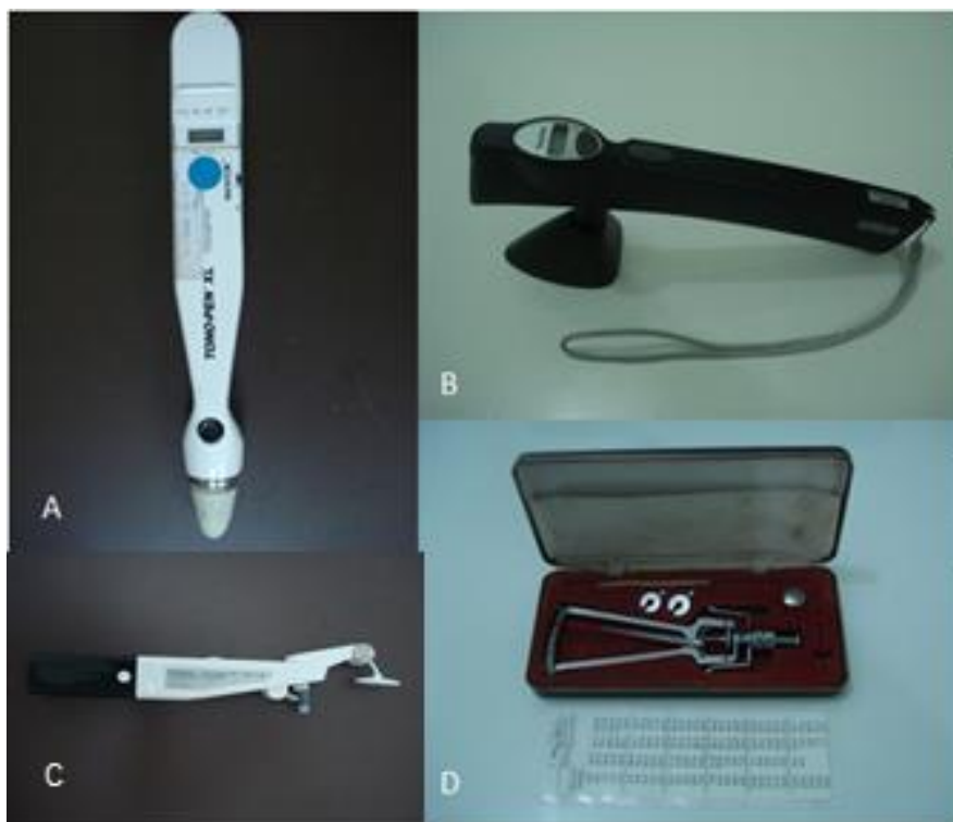
Figura 1 - Principais tonômetros de aferição da pressão intraocular utilizados em medicina veterinária. (A) Tonopen XL. (B) Tonovet. (C) Tonometro de Perkins. (D) Tonometro de Schiotz.
