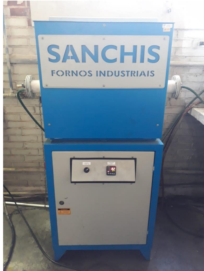
Figura 13 - Forno tubular resistivo do Laboratório de Transformação Mecânica (LdTM) da Universidade Federal do Rio Grande do Sul. Fonte: Elaborado pelo autor (2019).
