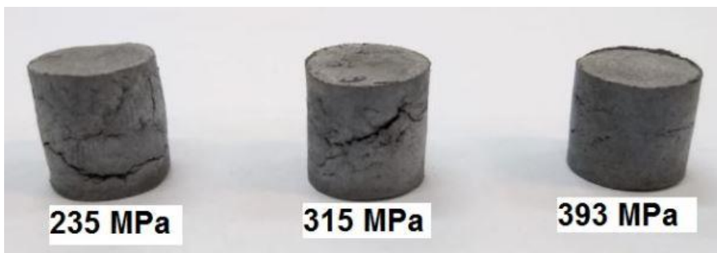
Figura 9 - Amostras após extração química, fabricadas com diferentes pressões para testes preliminares.
