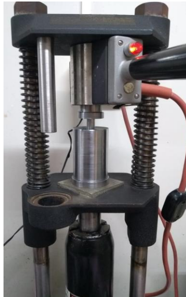
Figura 10 - Prensagem do pó metálico (prensa hidráulica). Fonte: Elaborado pelo autor (2019).
