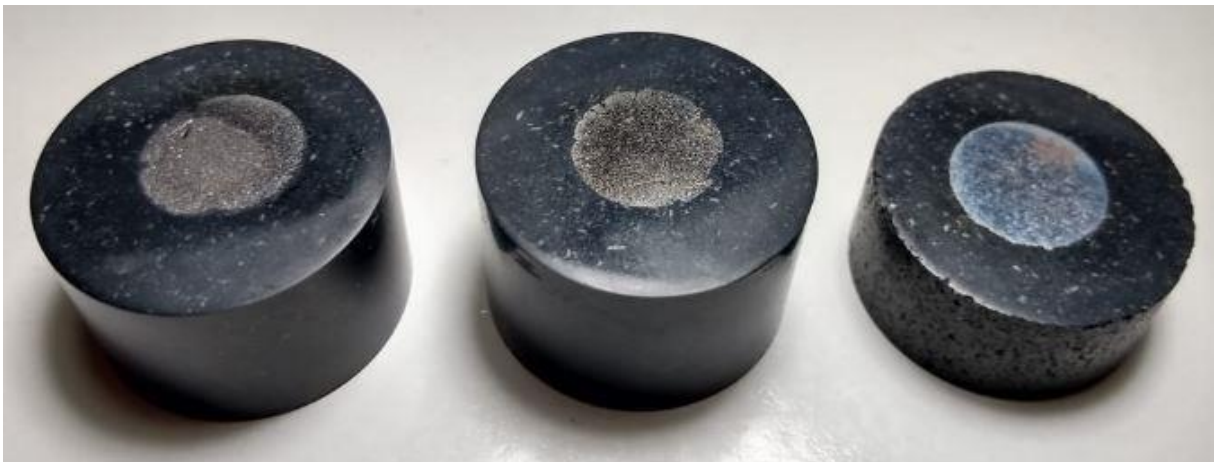
Figura 15 - Amostras embutidas em baquelite após sinterização Fonte: Elaborado pelo autor (2019).
