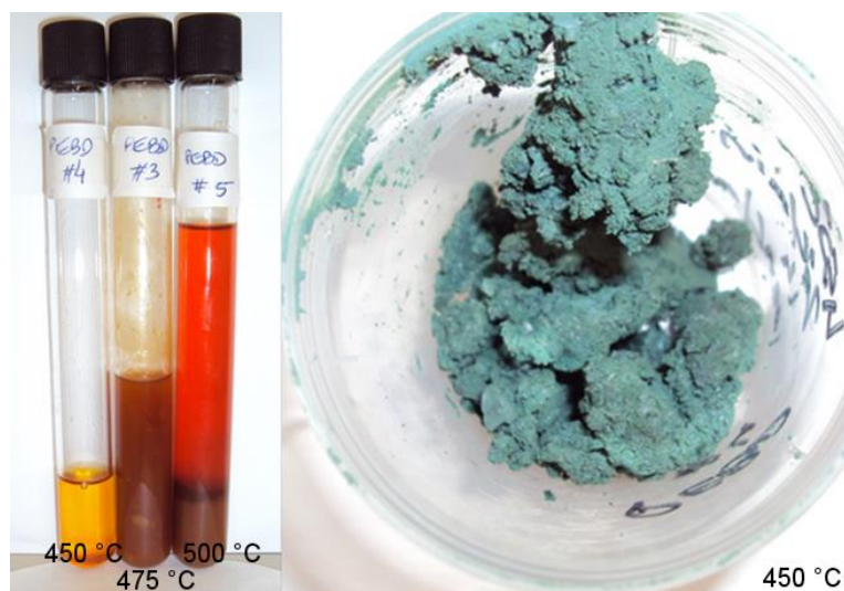
Figura 55 – Produtos obtidos na pirólise de PEBD pós-uso
