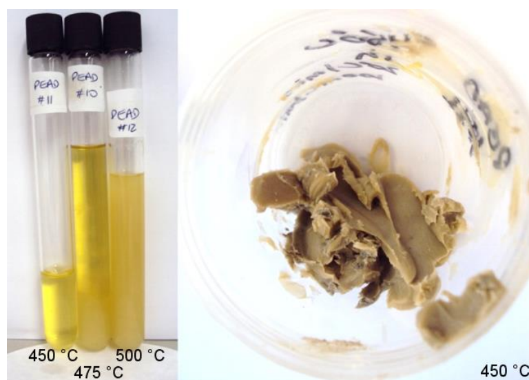
Figura 53 – Produtos obtidos na pirólise de PEAD pós-uso
