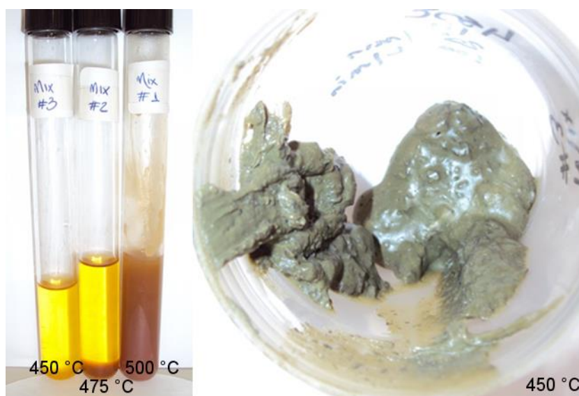
Figura 61 – Produtos obtidos na pirólise de mistura de resíduos poliméricos
