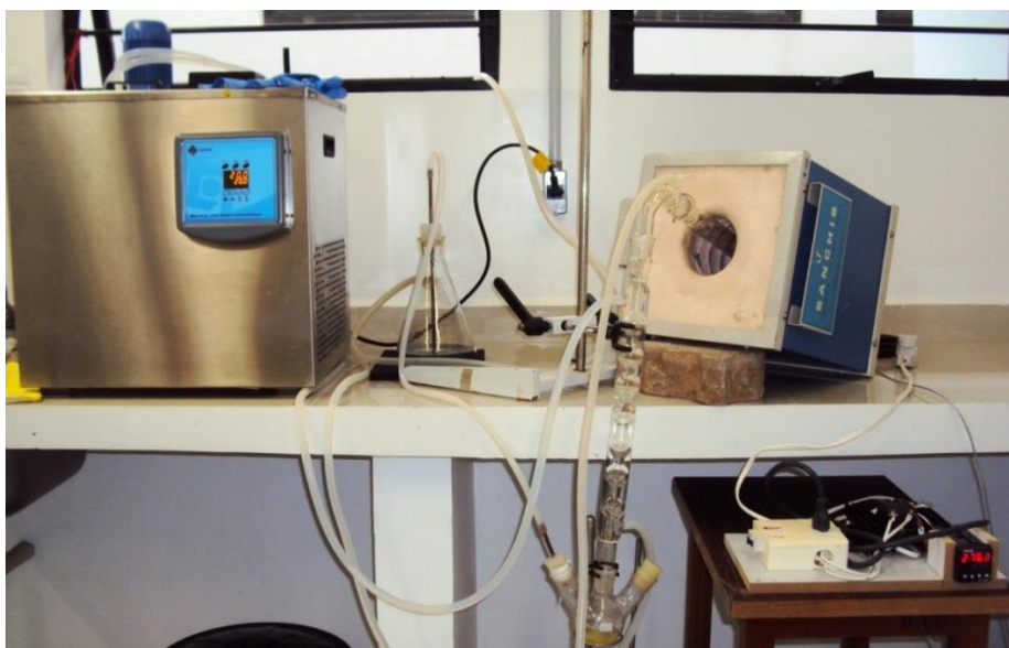
Figura 27 - Experimento de pirólise em batelada
