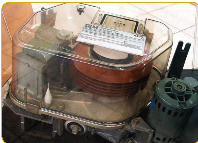
Figura A.5 – Disco rígido da IBM (Fonte: ver lista de créditos de imagens 04)
