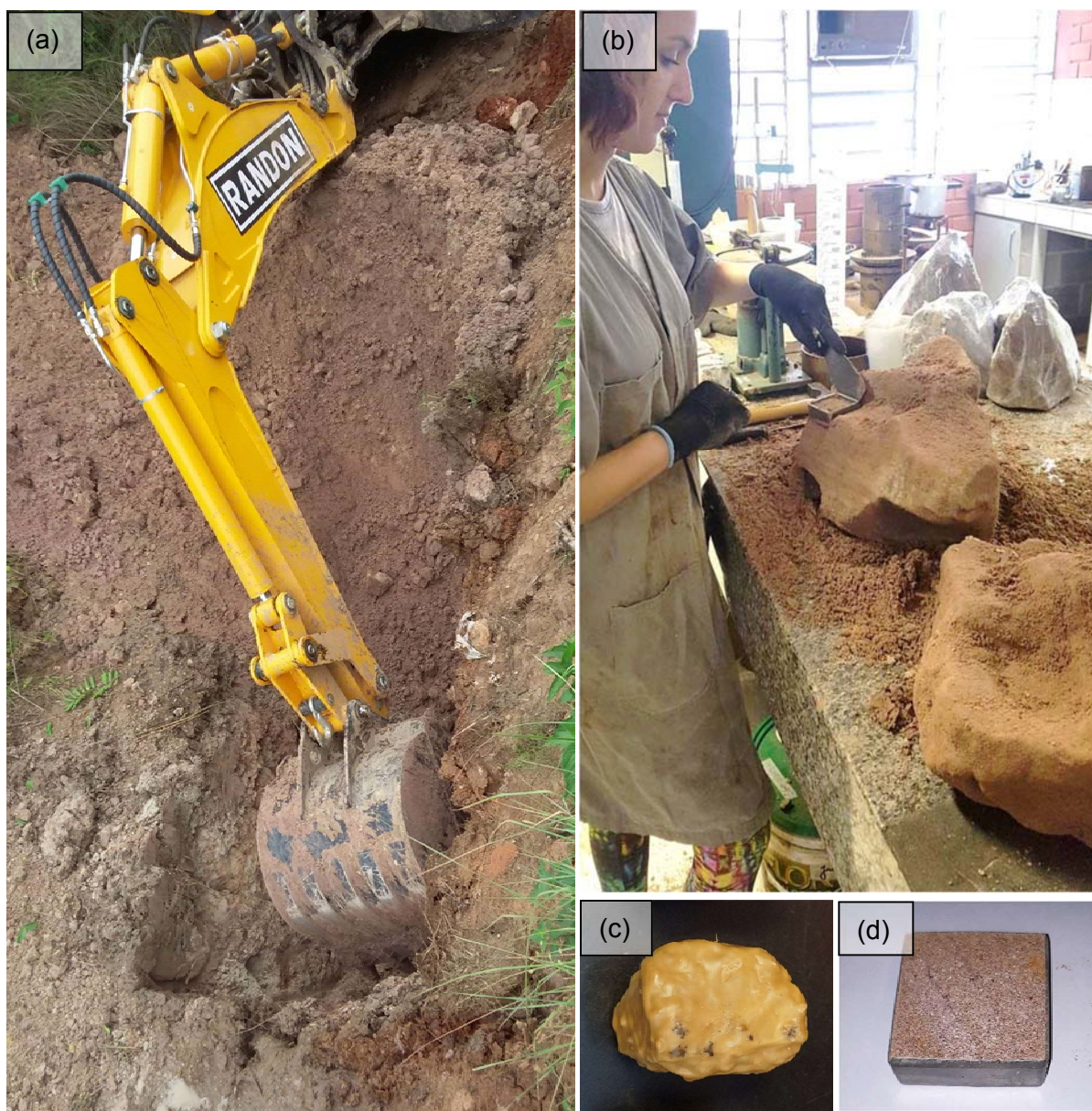
Figura 4.7 – (a) Coleta do material em campo; (b) moldagem dos anéis em laboratório; (c) amostra parafinada e (d) amostra pronta para ensaio de cisalhamento.
