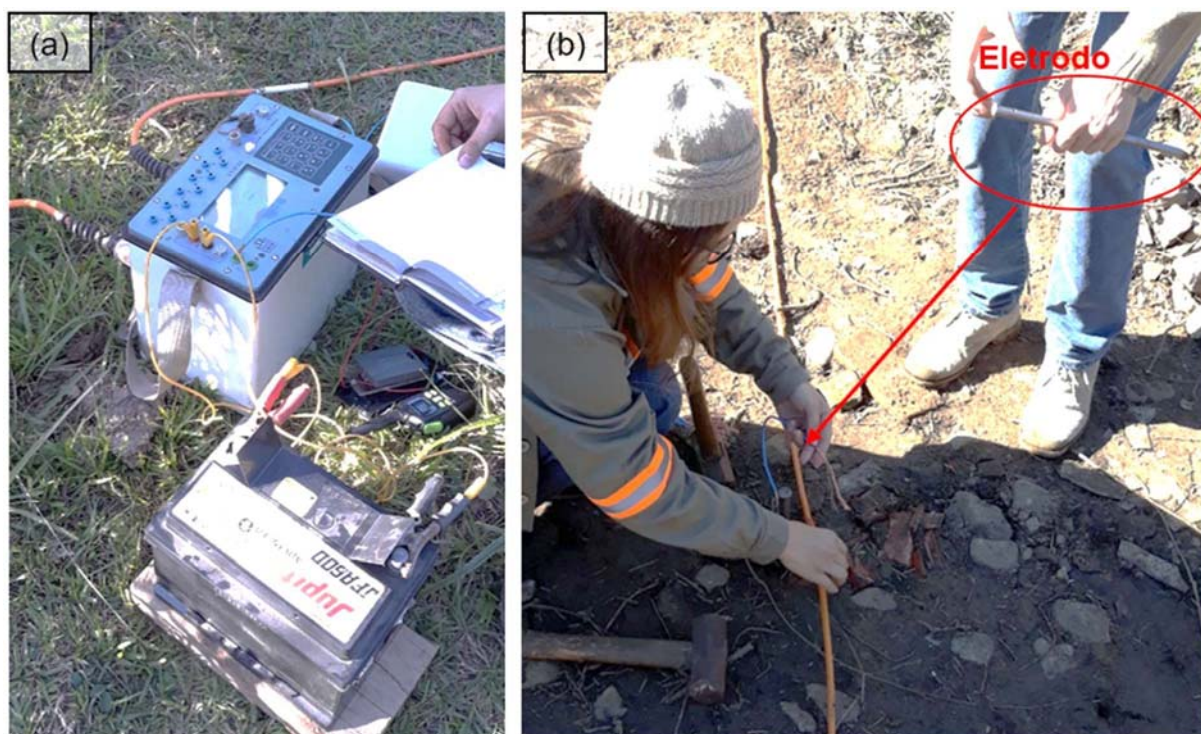
Figura 4.5 – Resistivímetro- conectado a bateria (a); conexão de um eletrodo a um dos multicabos (b).
