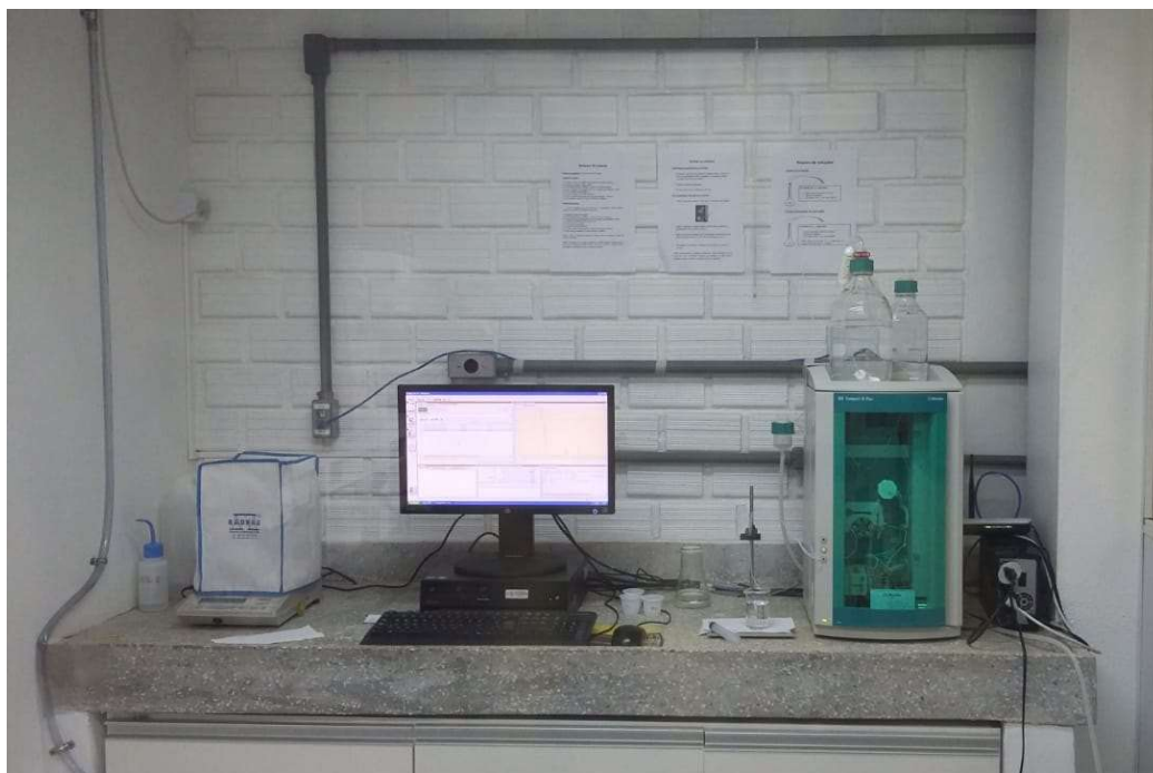
Figura 5 – Cromatógrafo 930 Compact IC Flex da Metrohm utilizado na determinação da concentração de íons fluoreto
