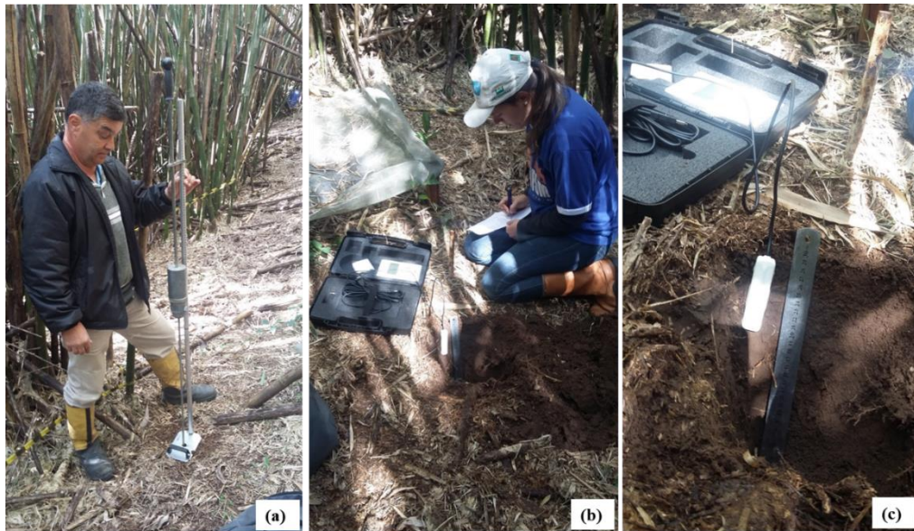
Figura 14 – Imagens do processo de coleta de dados via penetrômetro de impacto e sonda, em Eldorado do Sul, RS onde: (a) processo de tomada dos dados de resistência à penetração com penetrômetro de impacto; (b) leitura dos dados de umidade e temperatura do solo (c) sonda instalada no solo para leitura da temperatura
