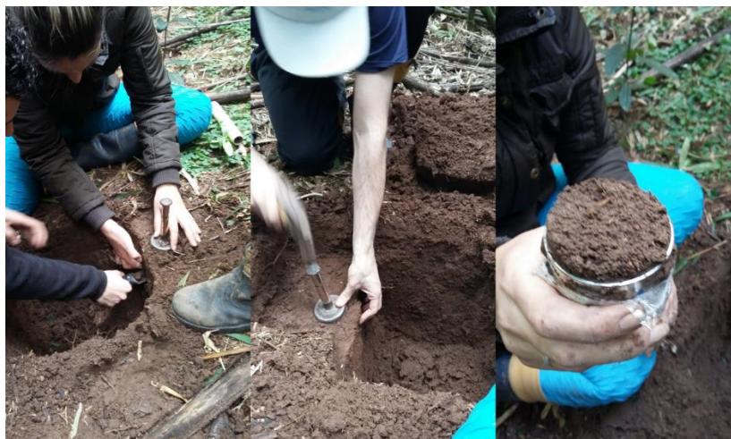
Figura 13 - Coleta de amostras indeformadas do solo pela técnica do anel volumétrico em áreas submetidas a controle de B. tuldoides , Eldorado do Sul, RS
