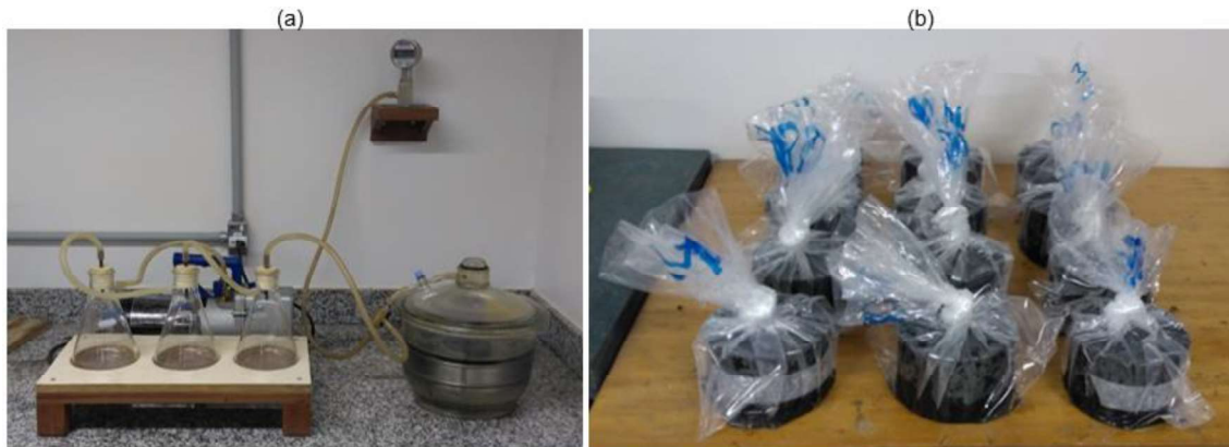
Figura 38 – Saturação (a) e preparo para congelamento (b) no primeiro grupo de amostras
