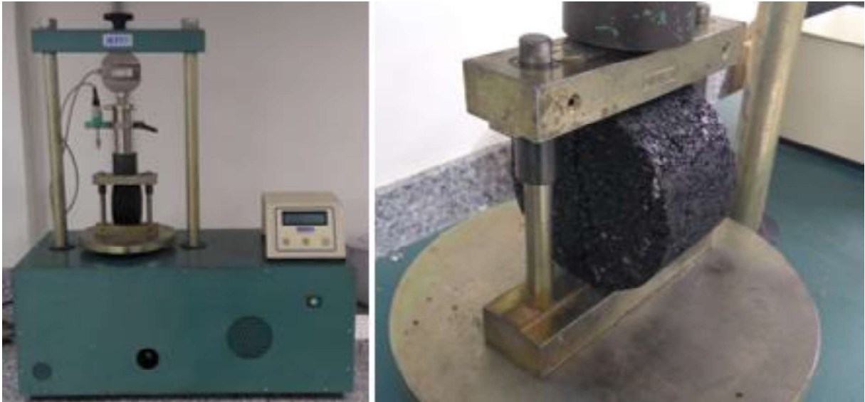
Figura 43 – Ensaio de Resistência a Tração por compressão diametral sendo realizado
