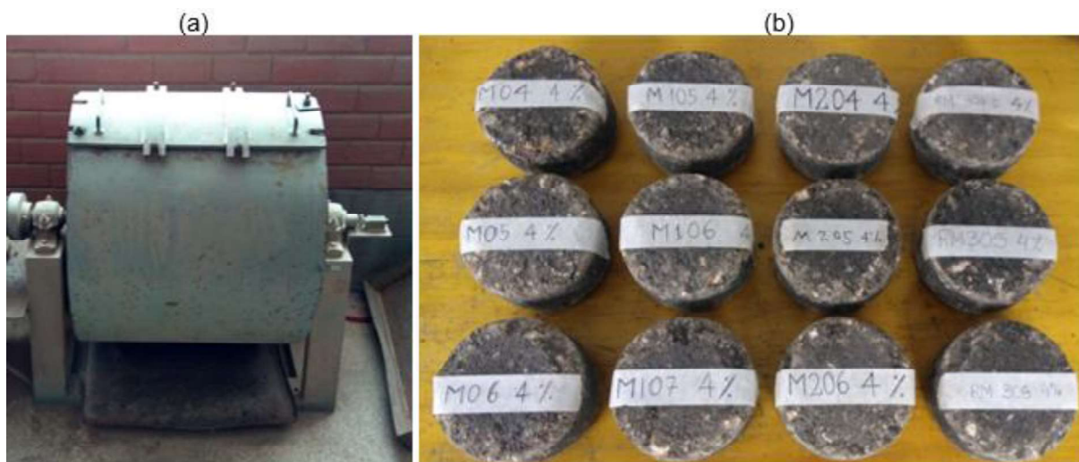
Figura 37 – Ensaio de Desgaste Cântabro: tambor (a) e amostras após ensaio (b)
