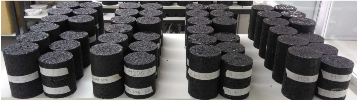
Figura 33 – Corpos de prova moldados para realização dos ensaios
