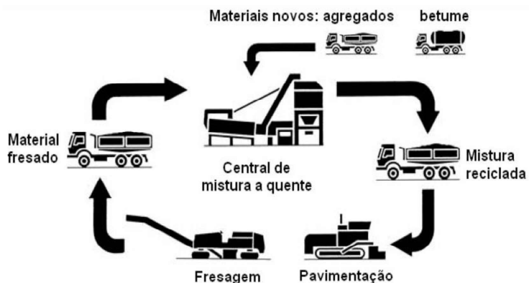
Figura 1 – Esquema de reciclagem à quente em usinas
