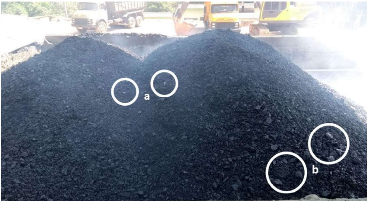
Figura 46 - Falta de envolvimento de ligante (a) e grumos nas misturas produzidas (b)
