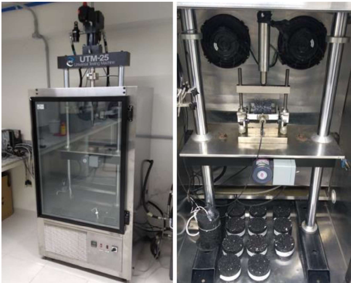
Figura 34 – Prensa UTM-25 e posicionamento dos CP's para o ensaio de MR
