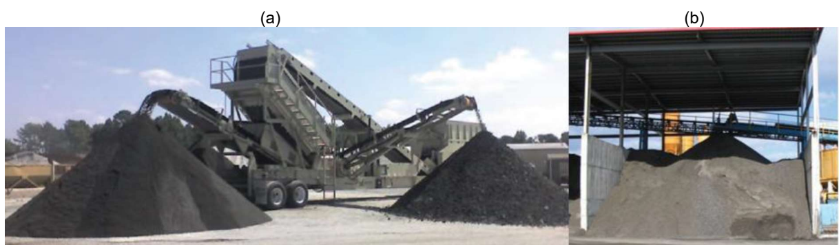
Figura 6 – Processo de separação de frações (a) e o armazenamento do RAP (b)
