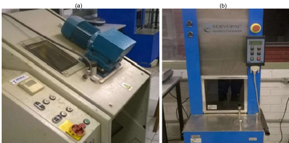
Figura 32 – Misturador (a) e compactador giratório Superpave (b) para moldagem de amostras
