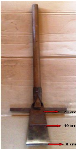
Figura 5: Cavadeira Modificada para coleta de amostras de solo. Fonte: Drakkar Solos.
