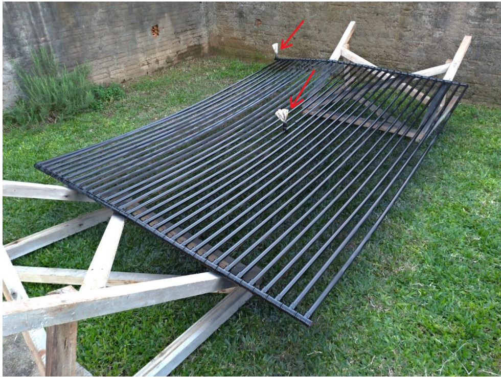
Figura 17 - Coletor finalizado. As setas vermelhas indicam os locais de instalação dos sensores de temperatura.
