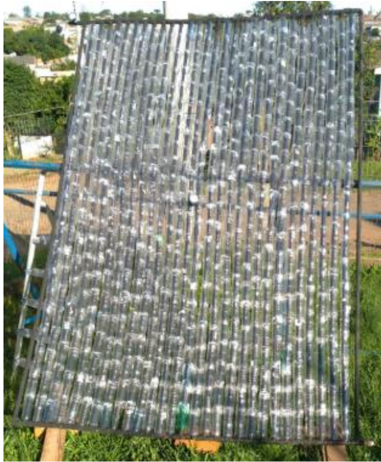
Figura 19 - Coletor solar com cobertura.
