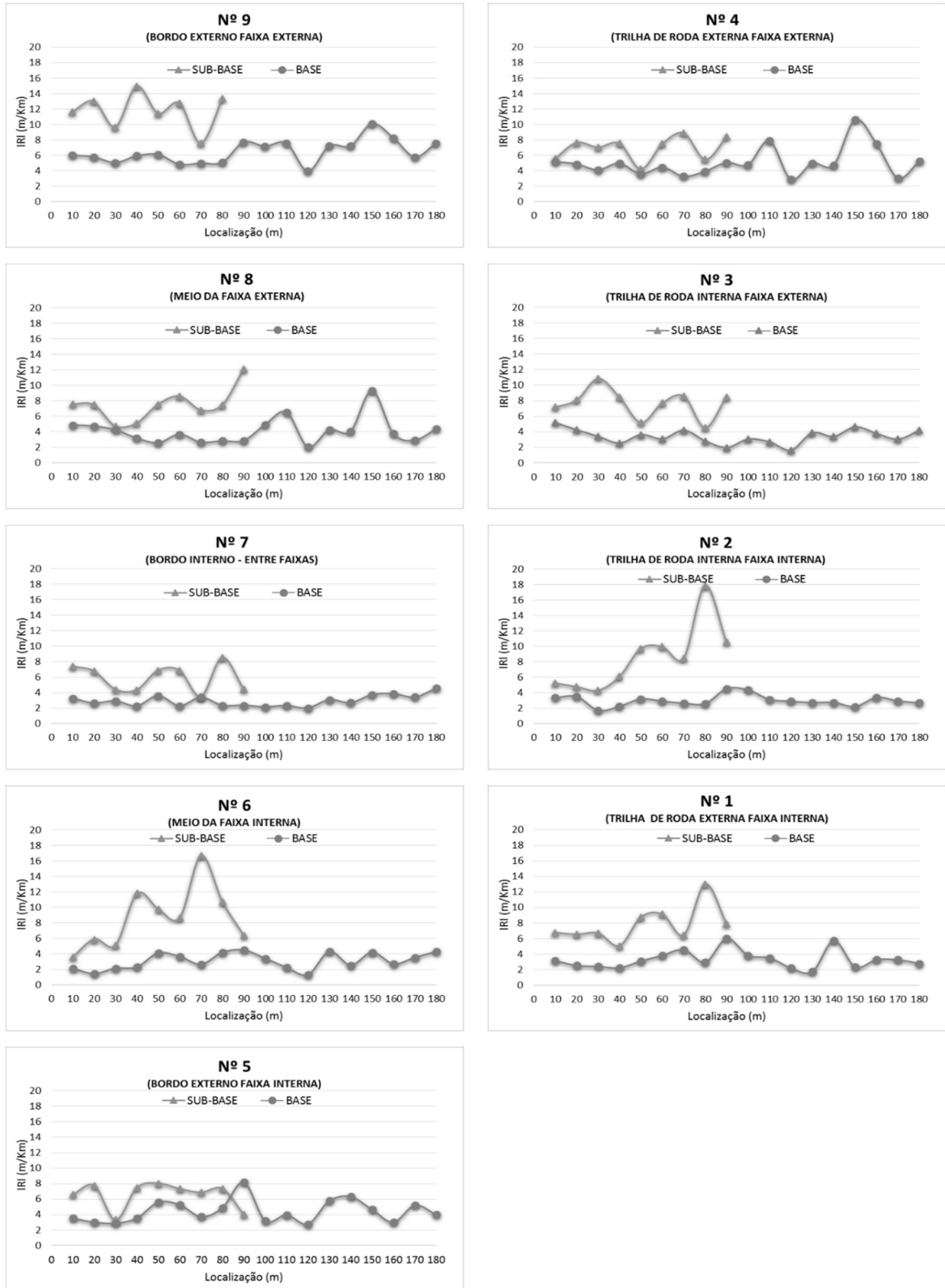
Figura 83 - Dados de irregularidade longitudinal nas camadas de sub-base (MS) e base (BGS) - Segmento 1 do Trecho ERS-509 desta pesquisa
