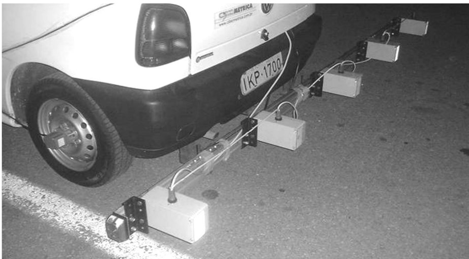
Figura 21 – 1ª Versão do perfilômetro inercial Ciberlaser
