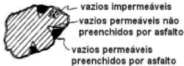
Figura 2.5 - Ilustração da massa específica efetiva dos agregados.
