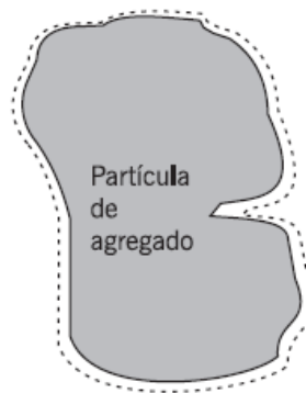
Figura 2.3 - Esquema volume da partícula do agregado.
