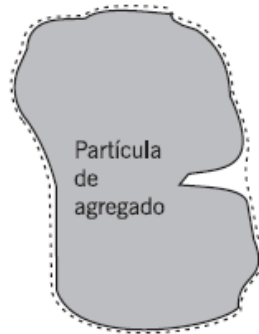
Figura 2.4 - Esquema da partícula superfície saturada seca.
