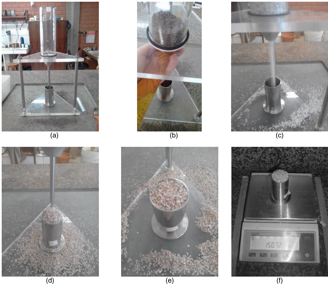
Figura 3.10 - Procedimento ensaio FAA, (a) equipamento; (b) agregado fino acomodado; (c) queda livre do agregado fino; (d) após a queda; (e) agregado fino rasado para pesagem; (f) pesagem do agregado.
