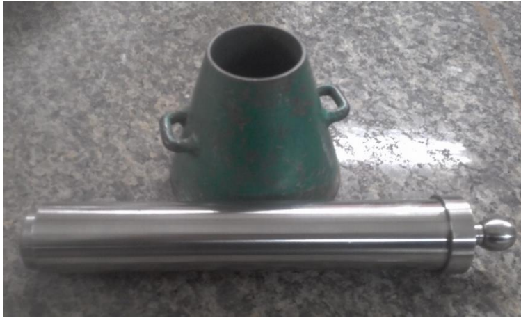
Figura 3.7 - Equipamento utilizado no ensaio de massa específica.
