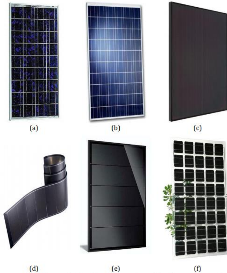
Figura 19 – Exemplos de módulos fotovoltaicos (a) (b) silício policristalino, (c) silício amorfo, (d) filmes finos com encapsulamento flexível, (e) CIS e (f) silício monocristalino com encapsulamento vidro-vidro.
