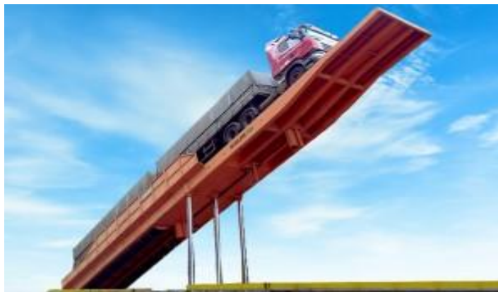
Figura 7 – Primeira plataforma de 30m com capacidade de descarregamento de 80 ton
