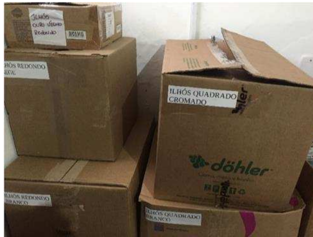
Figura 7 - Caixas de ilhoses após aplicação dos sentidos de organização, ordenação e limpeza
