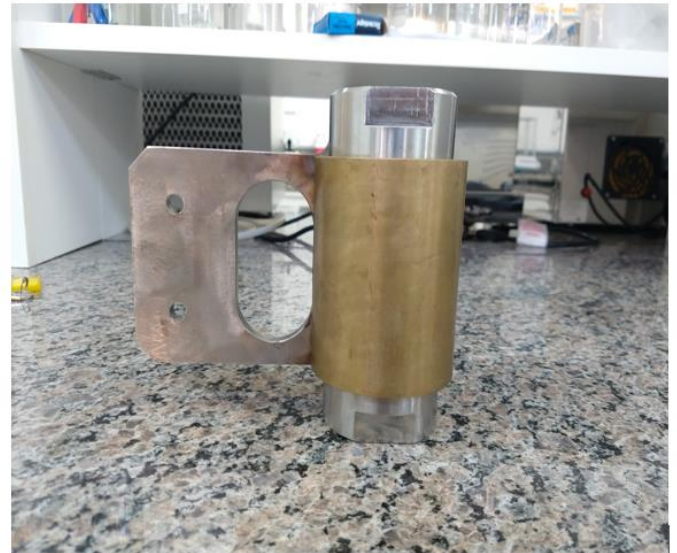
b) Reator sem a manta térmica prestes a ser introduzido na unidade de extração.
