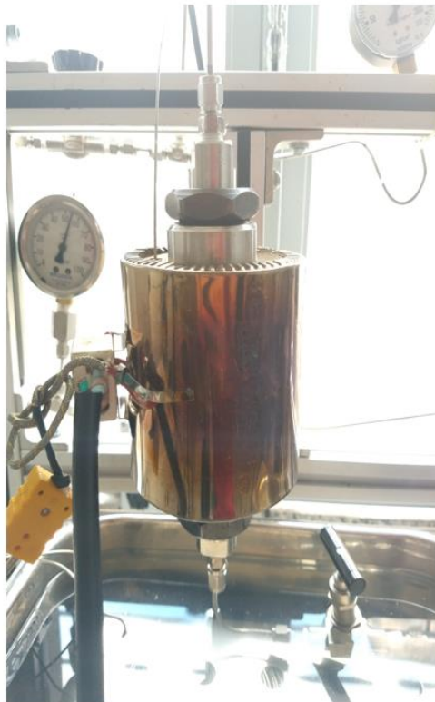
a) Reator com a manta térmica já instalado na unidade de extração.
