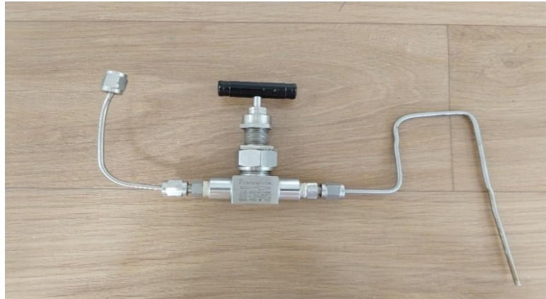
Figura 8 – Válvula de extração do tipo agulha micrométrica
