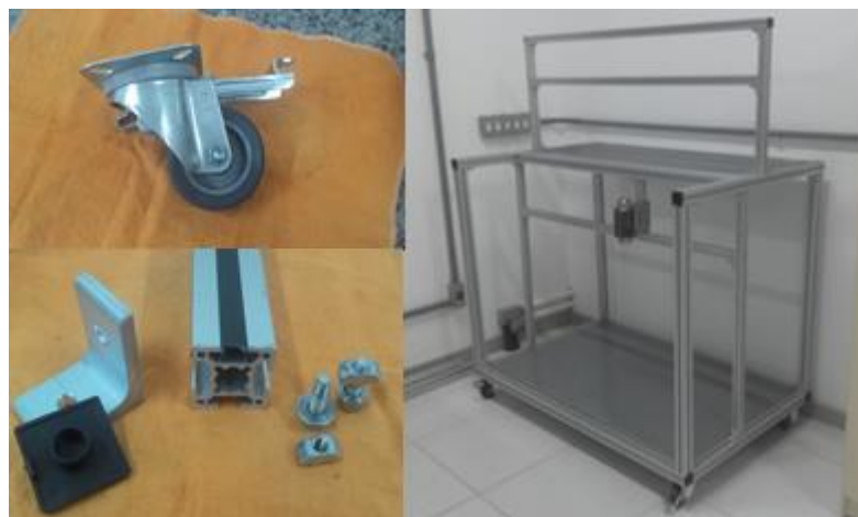
Figura 3- Base móvel e materiais utilizados na montagem
