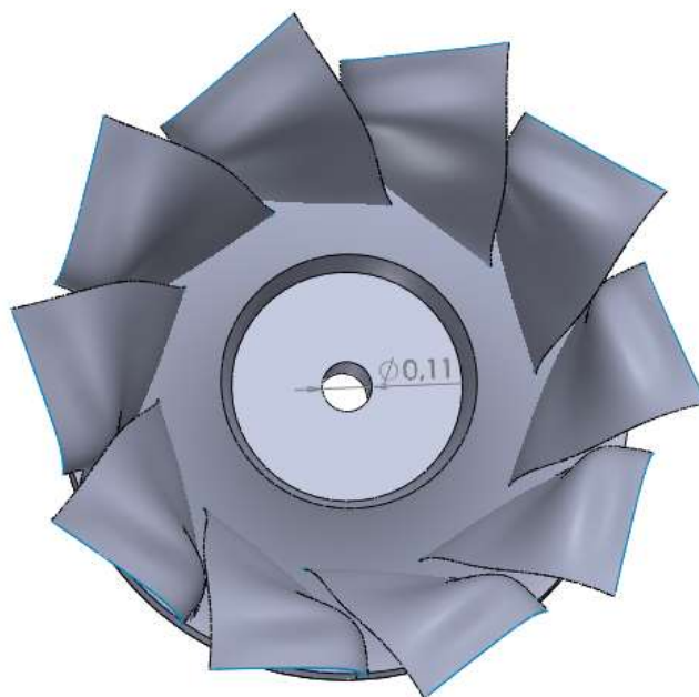
Figura 17 - Vista inferior da coroa interna com as pás dispostas
