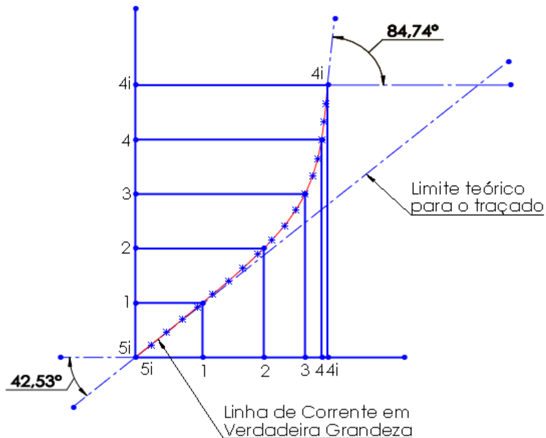
Figura 6 - Linha de corrente em verdadeira grandeza para coroa interna
