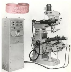
O controle numérico computadorizado é uma fase posterior ao desenvolvimento do controle numérico, ele trocou o controle de *hardware* por controle por *software*. Então foram desenvolvidos dois tipos de sistemas: o controle numérico direto e o controle numérico computadorizado. O que diferia um de outro, é que no primeiro um único computador central controlava diversas máquinas e no segundo, cada máquina era equipada com seu próprio processador (MARCICANO, 2017).
