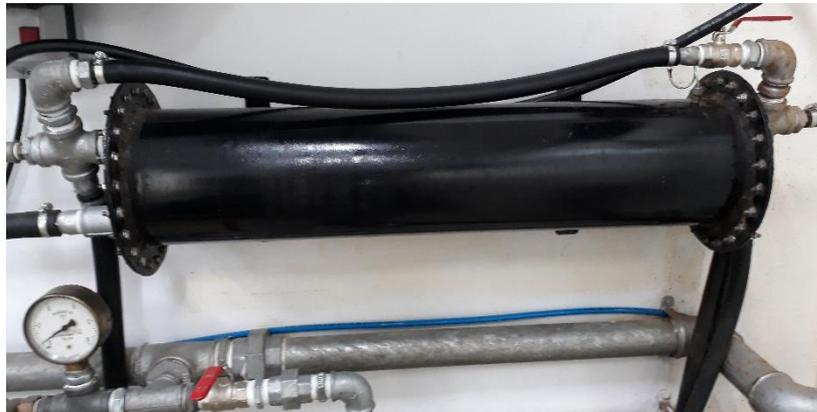
Para iniciar o funcionamento do motor de forma mais ágil e em alguns casos estabilizar a temperatura de ensaio foi necessária a instalação de uma resistência de aquecimento no circuito de circulação de fluido de arrefecimento. Nesta etapa foi utilizada uma resistência comercial de 8 kW / 220v (figura 22), instalada em um reservatório que foi confeccionado em aço carbono e fixado na saída da motobomba de arrefecimento.
