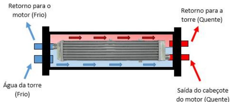
Figura 21 - Trocador de calor água/água instalado
