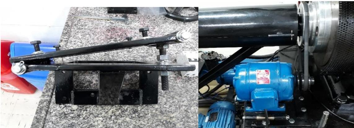
O sistema de transmissão (ligação entre o motor e o dinamômetro) foi feito através de um eixo cardan, sistema este que também teve que ser montado sobre medida para o motor (figura 19), a partir do dimensionamento em função da rotação e do torque calculado do motor. Foi feita uma seleção entre peças comerciais de veículos e foram utilizadas peças de um eixo cardan de uma Mercedes Bens Sprinter, modelo 311 CDI e também peças de uma Toyota Hilux 2004.
