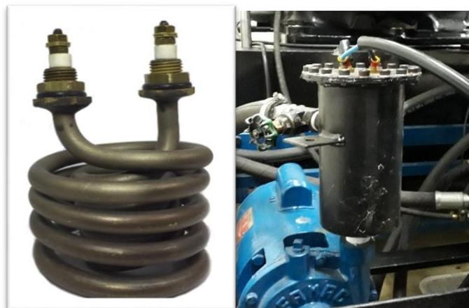
O sistema de lubrificação do motor já conta com resistências para aquecimento do óleo do carter de fábrica, é um sistema de duas resistências duplas de 500w cada, totalizando 2 kW de potência. O acionamento e controle das resistências foi feito de forma manual.
