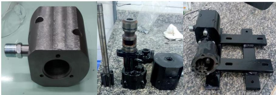
Figura 17 - Unidade de bombeamento de óleo finalizada
