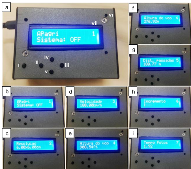
Figura 4. Funções da caixa de comando do sistema de sistema de disparo de fotos automáticas a ser acoplado em um avião agrícola.
