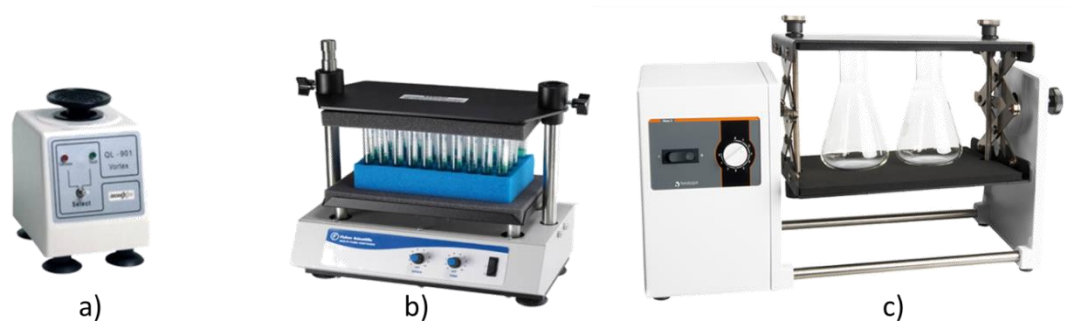
Figura 7–Agitadores utilizados durante a etapa de extração: a) vortex comum, b) Multitube Vortex Fisher Scientific®, c) Heidolph Overhead Shaker Reax®
