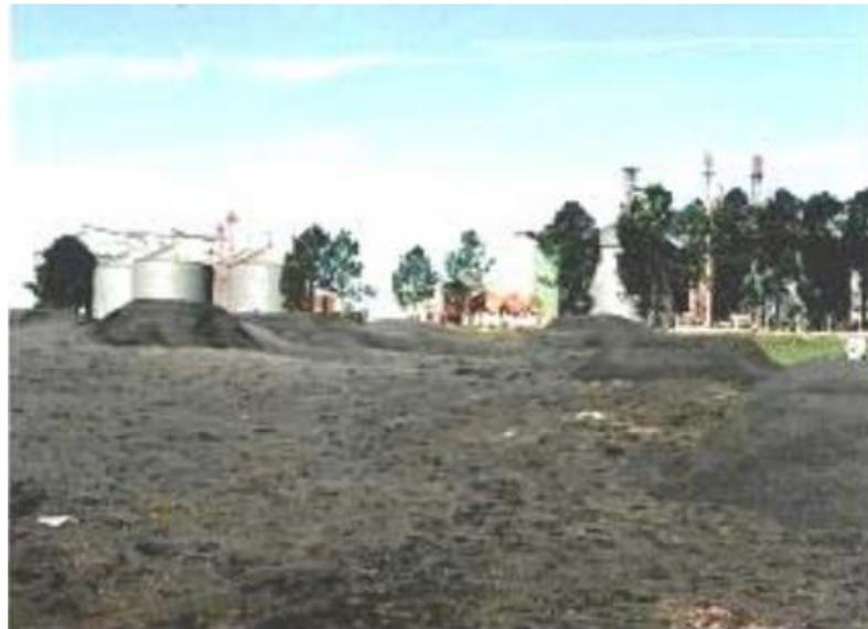
Figura 6 - Depósito de cinza de casca de arroz a céu aberto.
