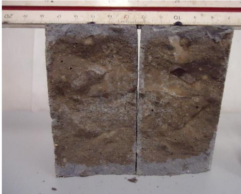
Figura 29 . Corpo de prova após aspersão de nitrato de prata.
