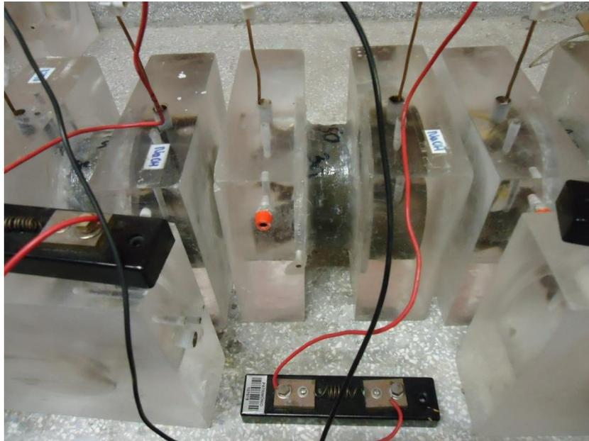
Figura 27 - Corpo de prova entre as células de acrílico.
