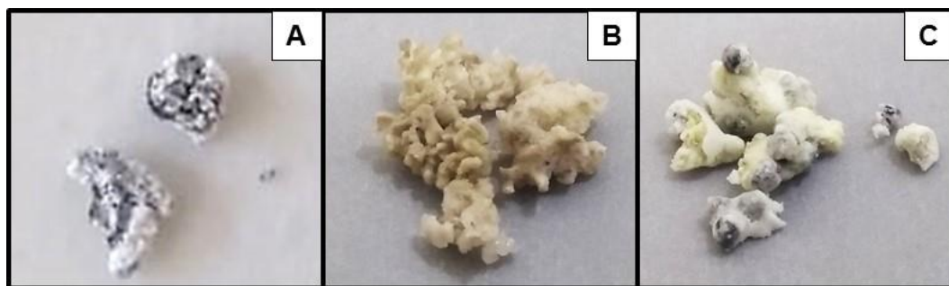
Figura 9 – Resíduos sólidos provenientes da combustão iniciada por micro-ondas das amostras: A) MET; B) REPA e C) SITA.
