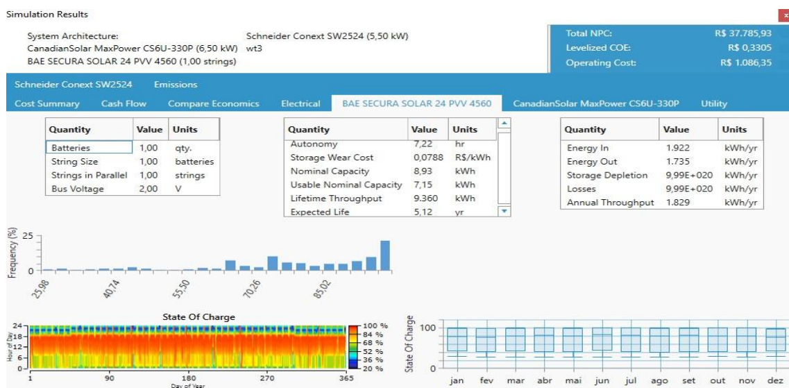
Figura55: Operação da bateria – 30km/dia
