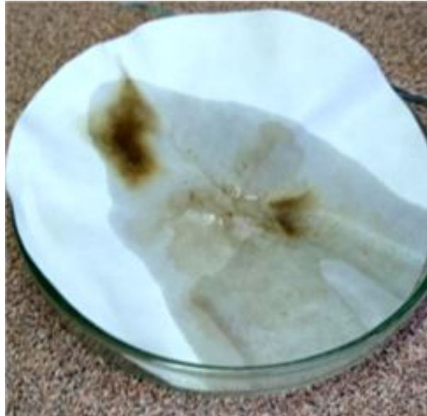
Figura 22- Determinação de taninos condensados pela adição de algumas gotas de potássio 5% sobre o insolúvel do tratamento sem sombreamento.
