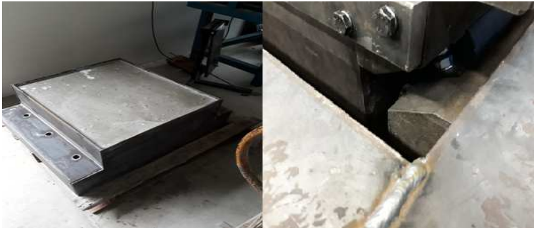
Figura 6 - Massa sísmica preenchida com concreto e coxins de acoplamento.
