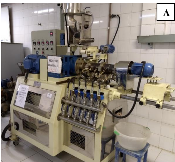
Figura 2 – Extrusora (A) e rações extrusada e peletizada em estufa de circulação de ar (B)
