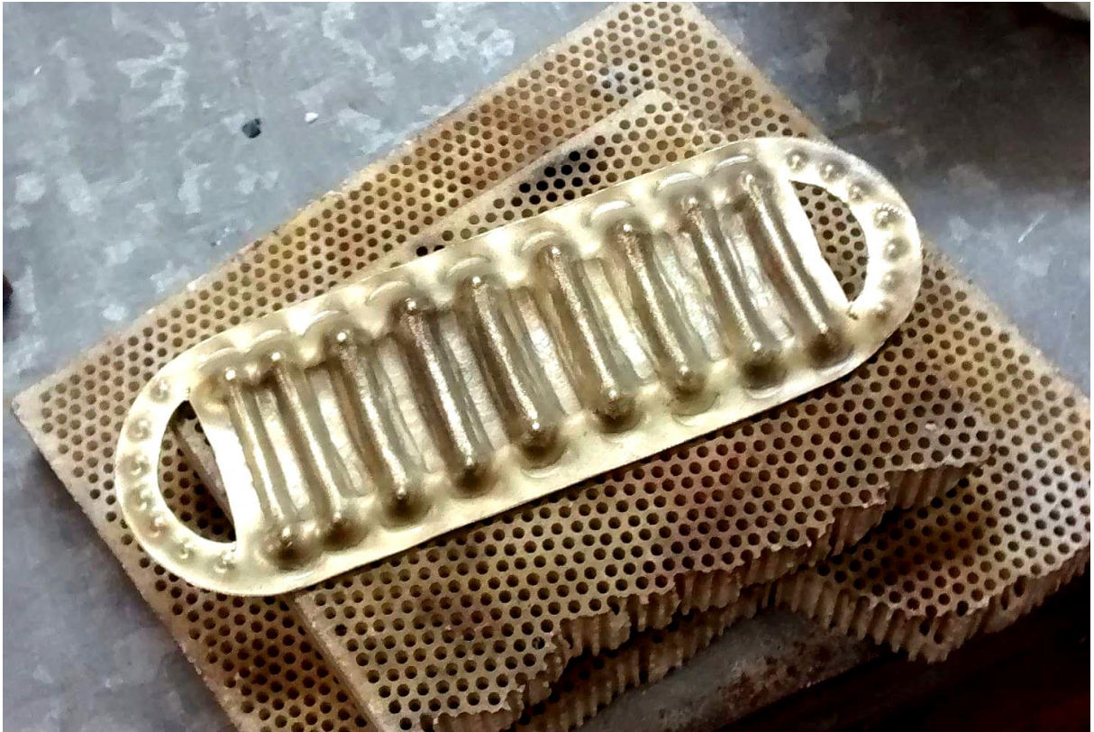
Figura 5 - Processo de cinzelado sobre latão 150x30 milímetros.
