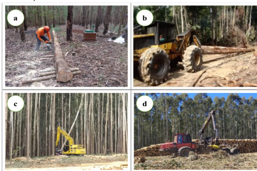
Figura 1 - Evolução da colheita florestal. a) uso de motosserra (manual), b) trator agrícola adaptado (semimecanizado), c) Harvester (mecanizado), d) Forwarder (mecanizado).
