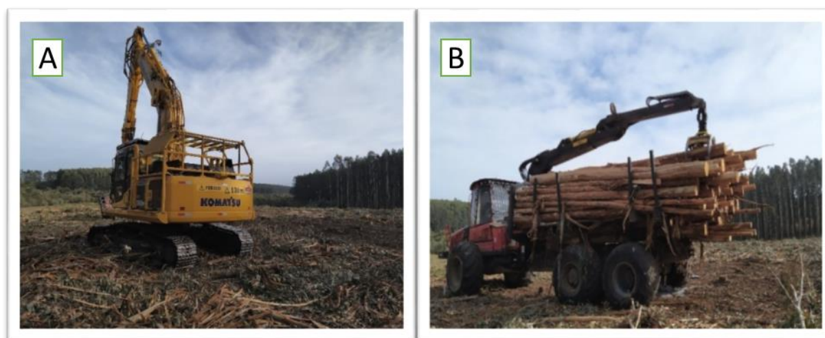
Figura 2 – Máquinas florestais utilizada na operação de colheita da madeira. A) Trator florestal Harvester utilizado na derrubada e processamento das árvores; B) Trator florestal Forwarder utilizado no transporte da madeira para a margem da estrada.
