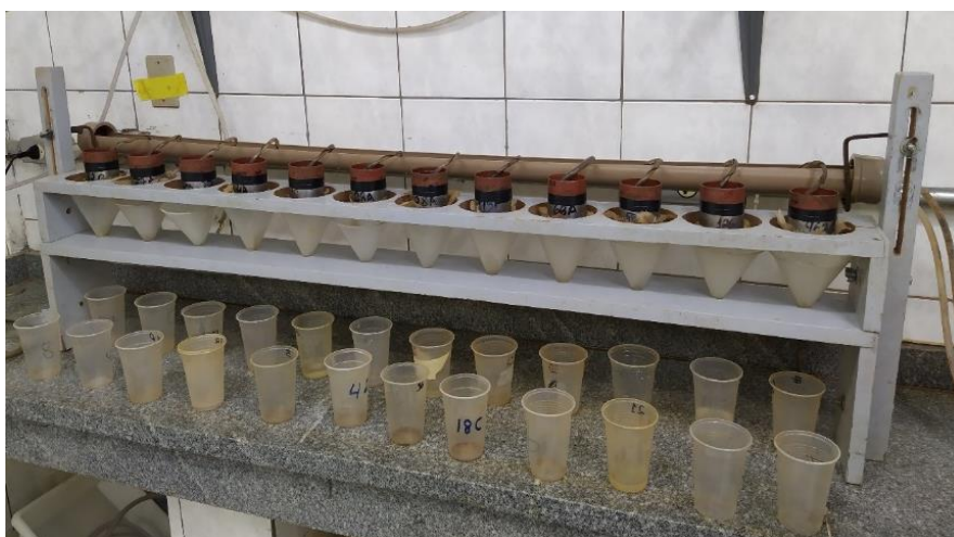
Figura 6 - Permeâmetro de carga constante utilizado nas medições de condutividade hidráulica do solo saturado.
