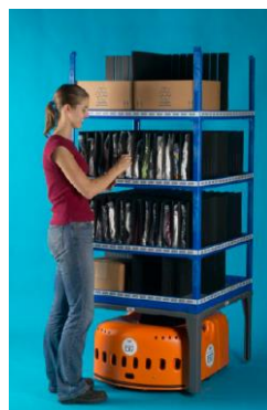
Figura 2 - Robô e prateleiras utilizadas pela Amazon em seus armazéns automatizados
