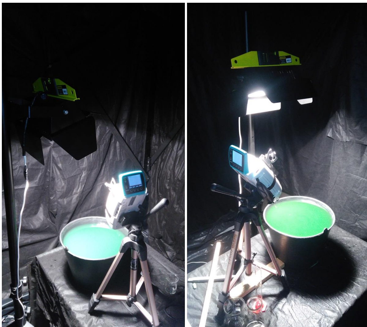
Figura 35: Aspecto interno da sala escura no decorrer das medições radiométricas. Em específico as medições realizadas para testar geometrias de aquisição e iluminação. Na figura da esquerda o tanque contém apenas amostras saturadas de Sphaerocavum sp. ; Na figura da direita foram inseridas alíquotas dos cultivos de Euglena sp. e Scenedesmus sp. , conjuntamente a Sphaerocavum sp. . A mudança na cor da água é evidente, no entanto, o ângulo de visualização também é um aspecto influente para esta mudança. Todos os materiais constados nas fotografias, exceto a mesa onde se encontra o tanque, o espectrorradiômetro e seu tripé foram adquiridos com recursos próprios.
