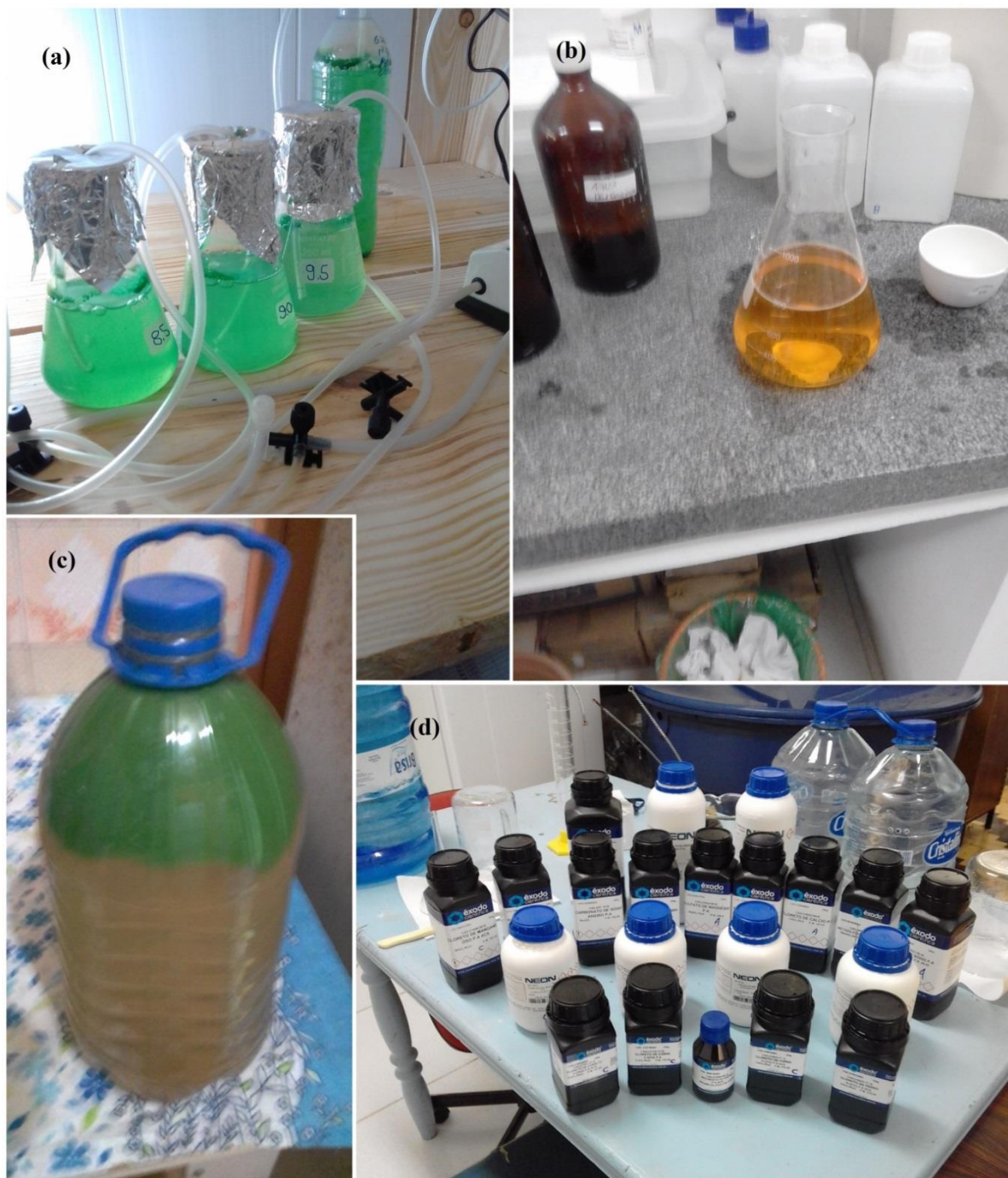
Figura 40: Experimento para ajuste de Ph, amostra de campo e materiais utilizados nos cultivos de fitoplâncton. (a) Cultivos de Cyanophyceae sp. em experimentação para ajuste de pH do meio de cultura. (b) Preparação das soluções do meio ASM1, no caso a solução de metais. (c) Amostra coletada em floração fitoplanctônica em um reservatório do campus da Universidade Federal de Santa Maria, a partir da qual Sphaerocavum sp. foi isolado. (d) Reagentes e/ou nutrientes adquiridos (Recursos próprios) para a preparação do meio de cultura ASM1, além de outros meios testados (Ex: Meio CHU) e ao fundo pode ser verificado o tanque de 1000 litros adquirido para a realização de radiometria.
