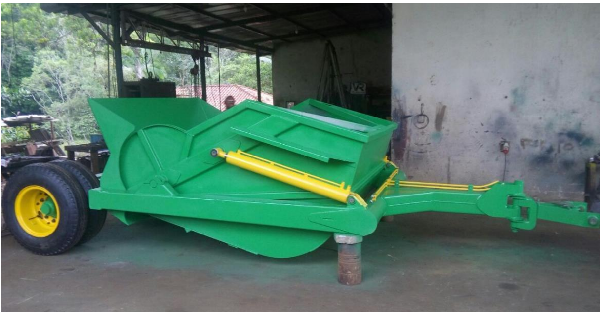
Figura 1 - Exemplo de caçamba scraper
