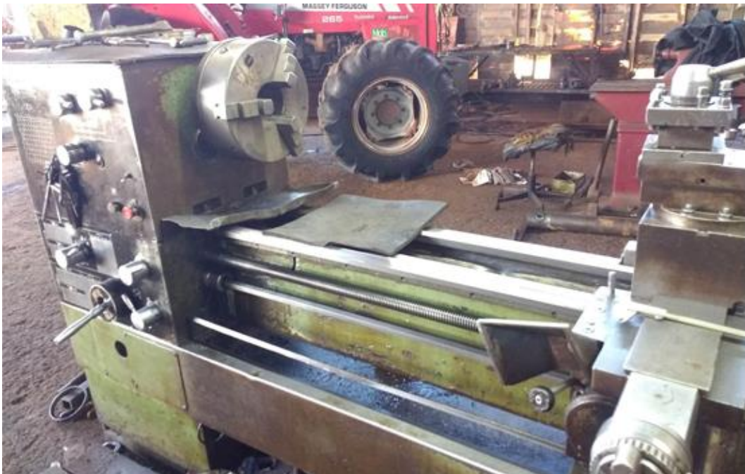
Figura 8 - Torno mecânico Nardini - ND325CS
