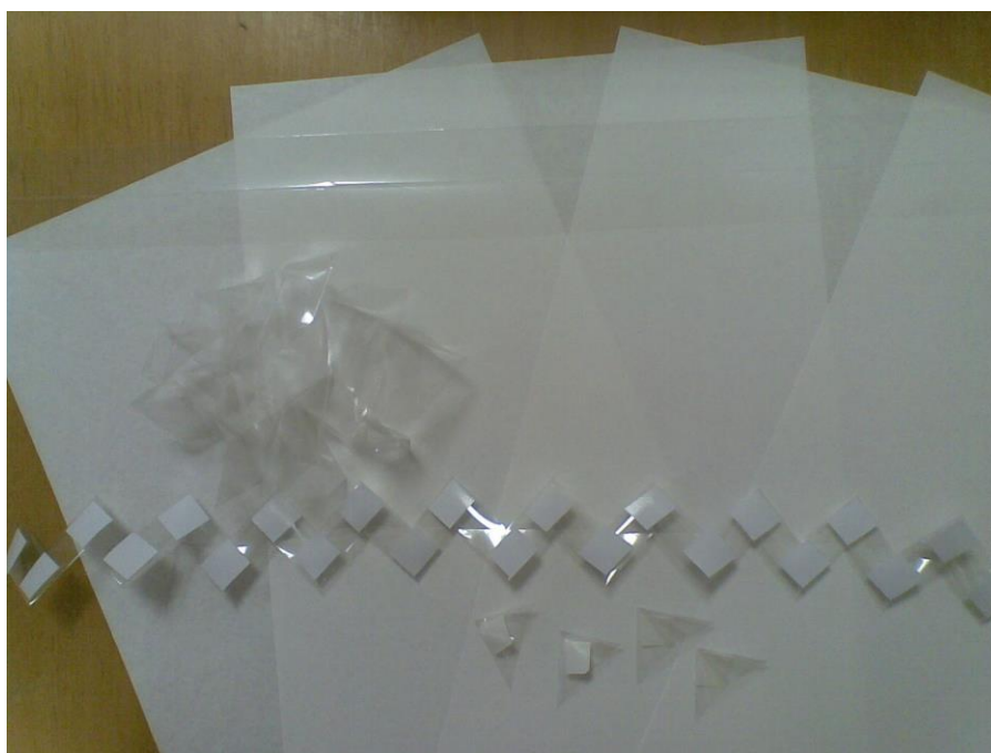
Figura 17 – Material utilizado no acondicionamento: folhas de Filiset Neutro e as cantoneiras nas suas quatro etapas de confecção. Fonte: A autora
