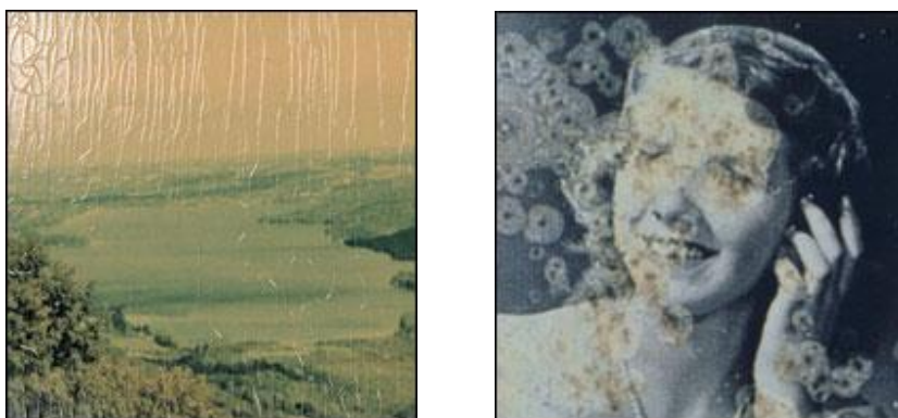
Figura 10 – Ação da baixa e alta umidade relativa do ar, respectivamente. Fonte: Image Permanence Institute 8
