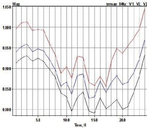
Fig. 10. Tensão das fases V1, V2 e V3 ao longo do dia no cenário base.
