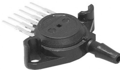
Figura A.6: Sensor de pressão absoluta do coletor de entrada MPX4250A utilizado nos ensaios.
