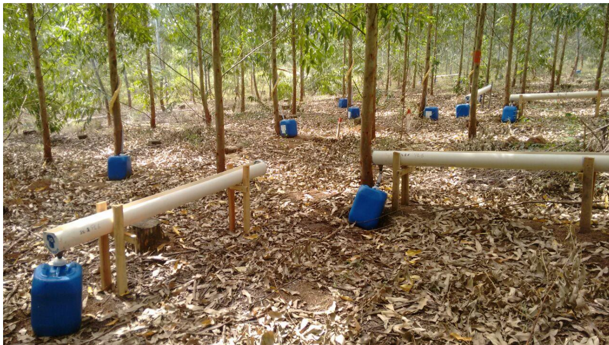
Figura 3 - Calhas lineares para a quantificação da precipitação interna na linha e entrelinha de plantio na parcela com a espécie Eucalyptus saligna jovem, São Gabriel-RS.
