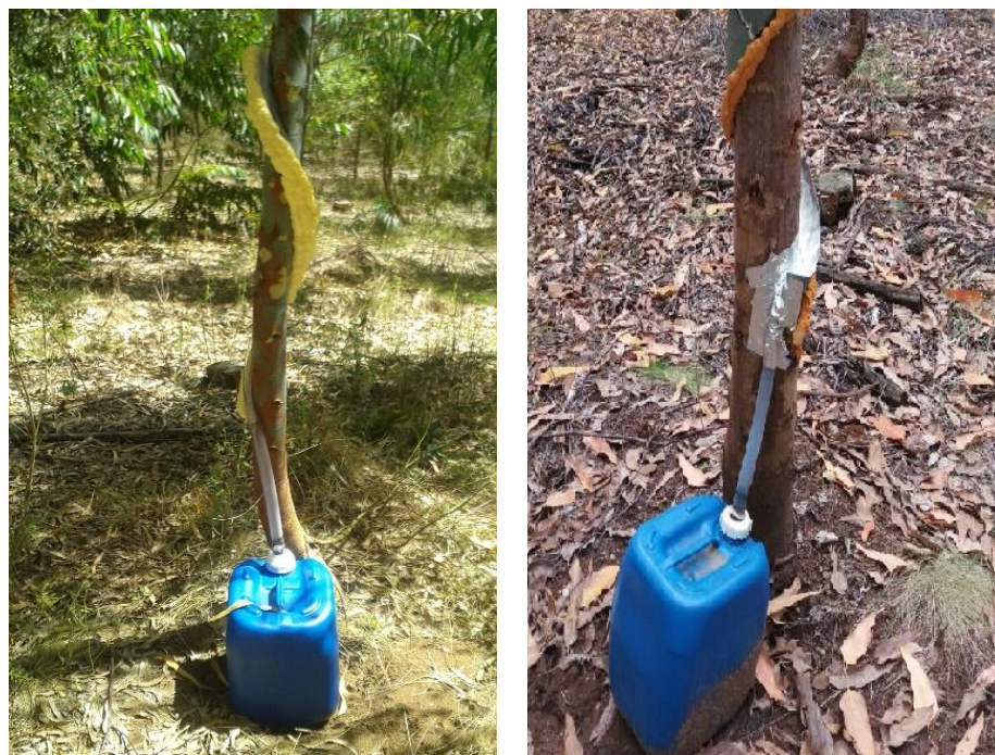
Figura 4 - Canaletas coletoras na forma de espiral para a quantificação do volume de água que escoa pelo tronco das árvores, São Gabriel-RS.
