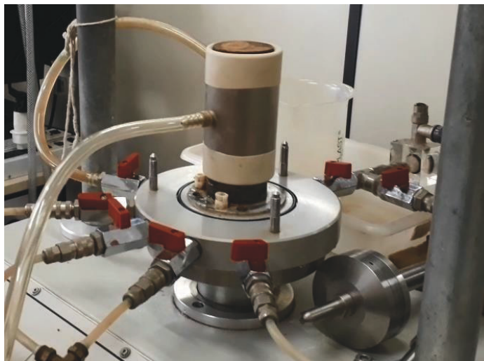
Figura A11 – Colocação da membrana látex para revestir a amostra.
