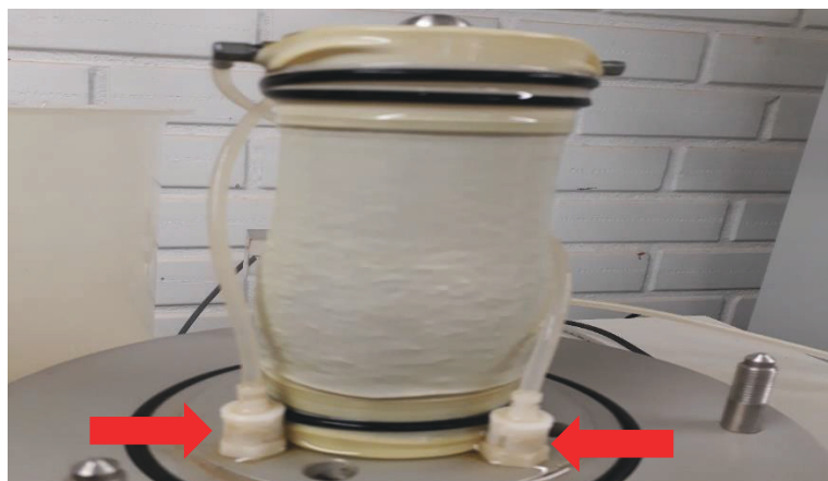
Figura A12 – Demonstração do encaixe das mangueiras do “top cap” na base da câmara.
