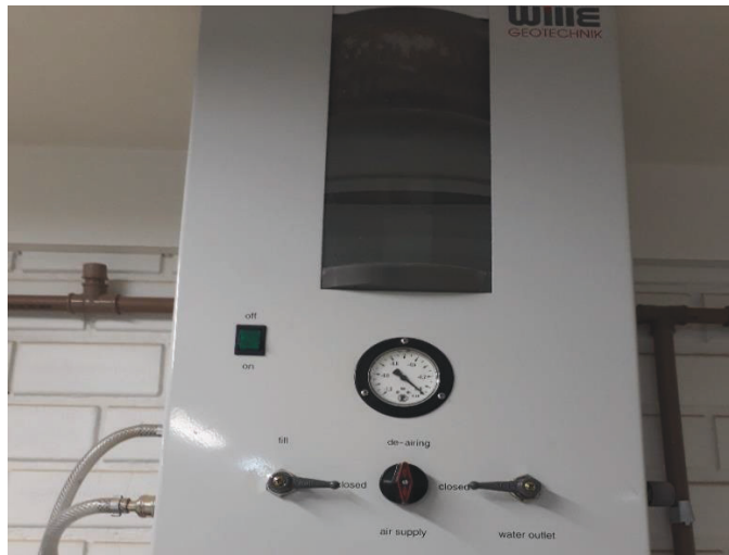
Figura A2 – Posição das válvulas do “DE-AERADOR” após processo de enchimento do mesmo.
