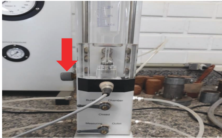
Figura A24 – Identificação da válvula de controle de vazão da bureta.
