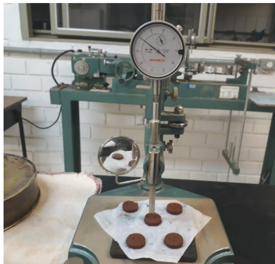
Figura 16 – Penetrômetro e pastilhas utilizadas no método das pastilhas para classificação MCT.
