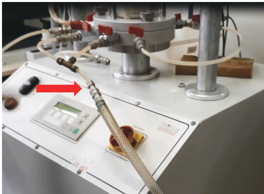
Figura A22 – Detalhe da conexão da mangueira do “DE-AERADOR” na ligação T.
