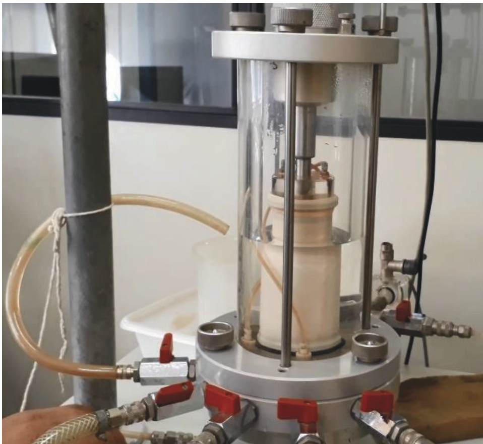
Figura A13 – Representação do enchimento da câmara com água.
