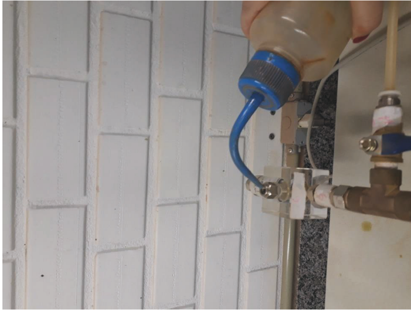
Figura A18 – Preenchimento do transdutor de pressão celular com água destilada.
