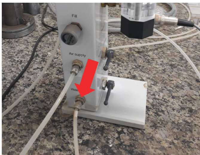
Figura A23 – Conexão da mangueira na bureta (entrada “Water Supply”).
