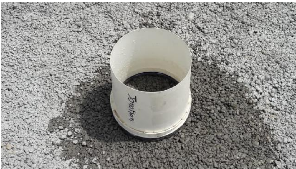
Figura 43 - Ensaio de permeabilidade em campo
