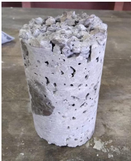
Figura 33 - Corpo de prova extraído
