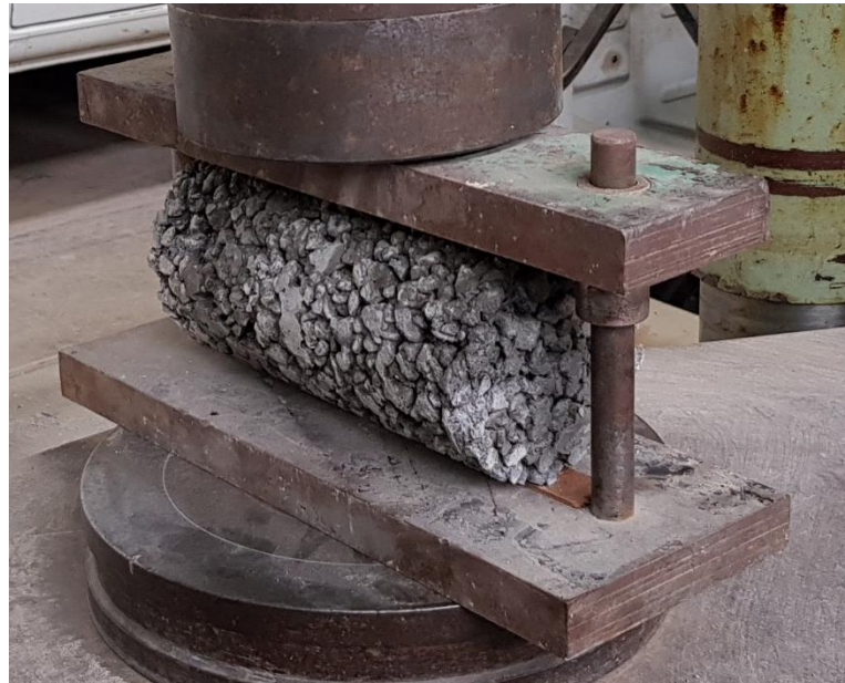
Figura 39 - Ensaio de resistência à tração por compressão diametral
