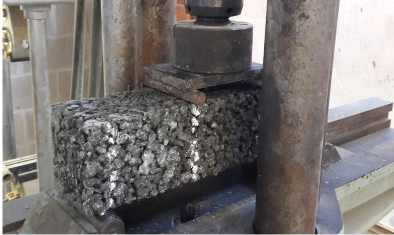
Figura 40 - Ensaio de resistência à tração na flexão
