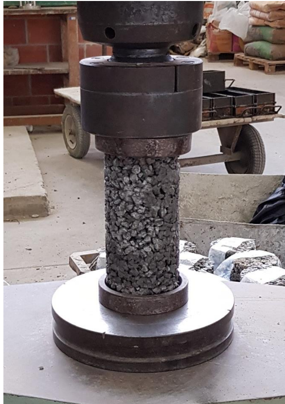
Figura 38 - Execução do ensaio de resistência à compressão axial
