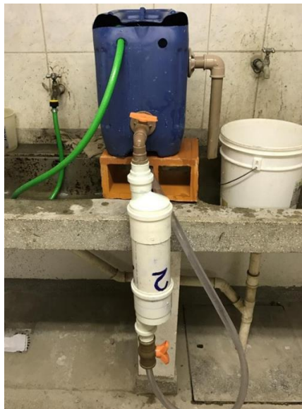
Figura 42 - Permeômetro de carga constante
