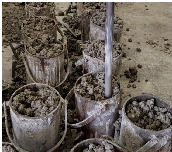
Figura 29 - Adensamento com haste metálica
