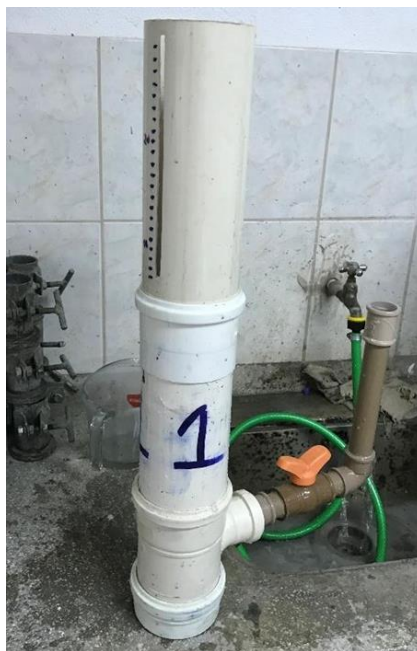
Figura 41 - Permeômetro de carga variável
