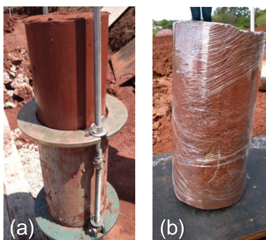
Figura 8 – (a) CP sendo retirado do amostrador e (b) protegido com plástico filme
