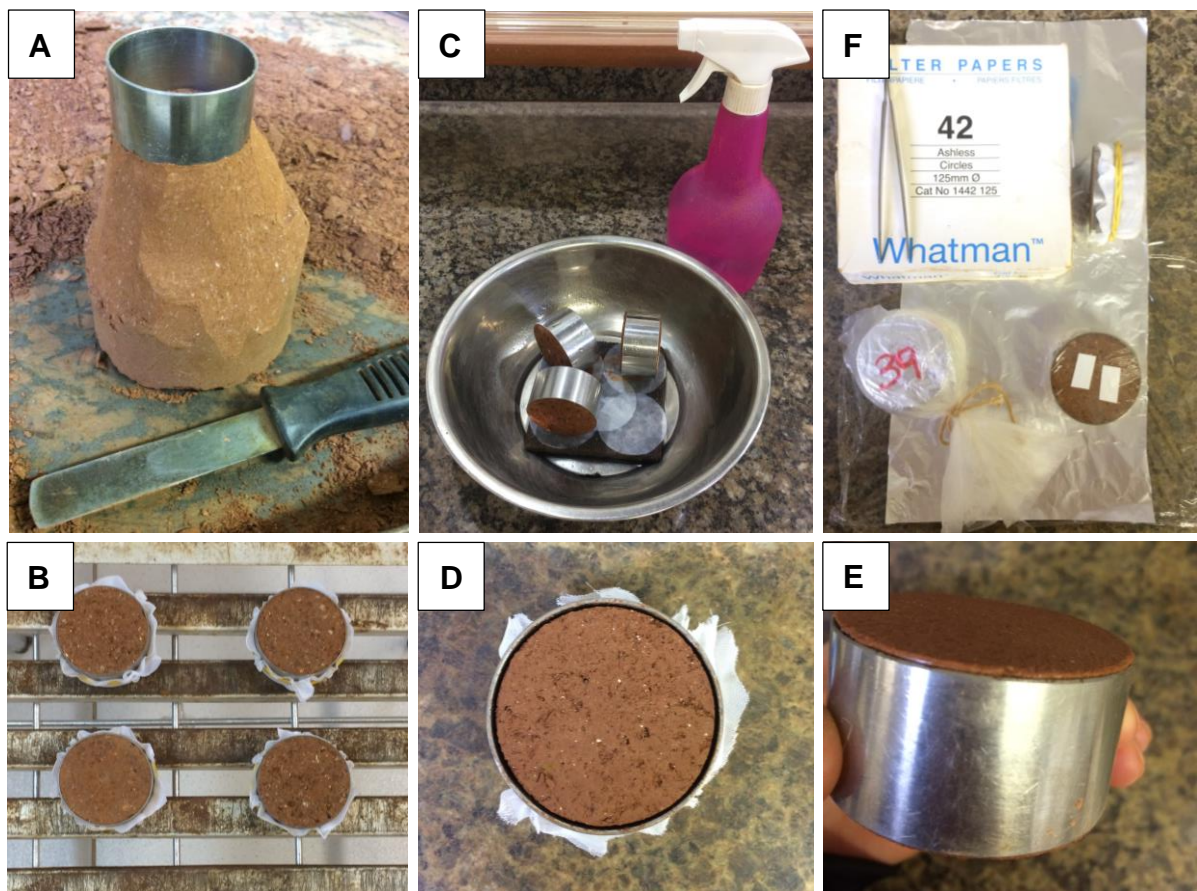
Figura 3.15 – Passo a passo para construção das curvas características dos solos pelo método do papel filtro
