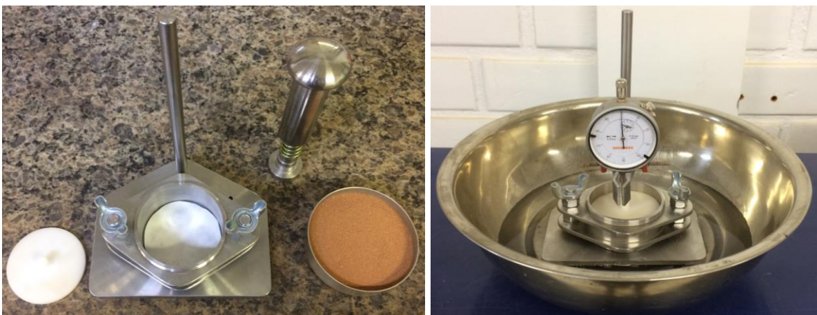
Figura 3.18 – Equipamento utilizado para o ensaio de expansibilidade LNEC
