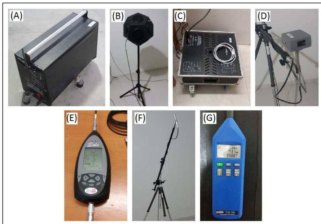
Figura 52 - Equipamentos utilizados nas medições: A) máquina de impacto; B) fonte acústica; C) amplificador; D) calibrador; E) sonômetro; F) microfone e pré-amplificador; e G) termo-higrobarômetro.
