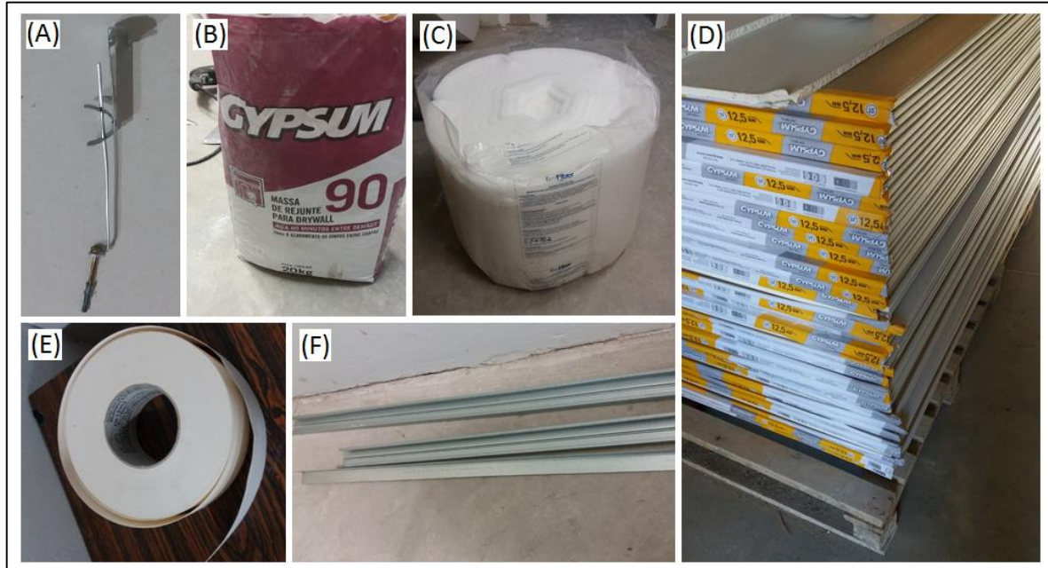
Figura 48 - Materiais utilizados para a execução dos forros: A) pendural metálico; B) massa de rejunte; C) lã de PET; D) placas de gesso acartonado; E) rolo de fita de papel especial microperfurado; e F) cantoneiras e canaletas de aço galvanizado.
