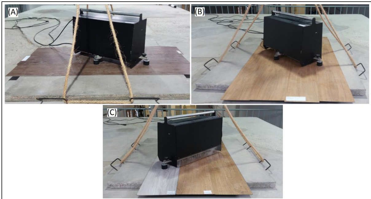
Figura 38 - Réguas vinílicas utilizadas nos ensaios: A) régua 2 mm; B) régua de 3 mm; e C) régua clicada de 4 mm.
