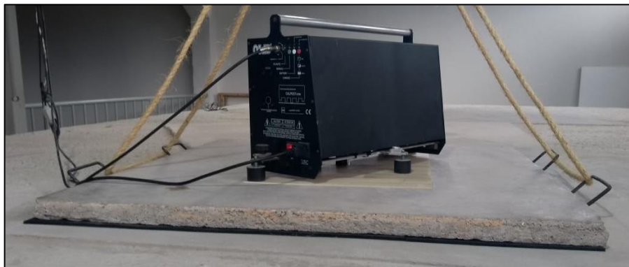
Figura 44 - Borracha reciclada sob amostra de contrapiso.
