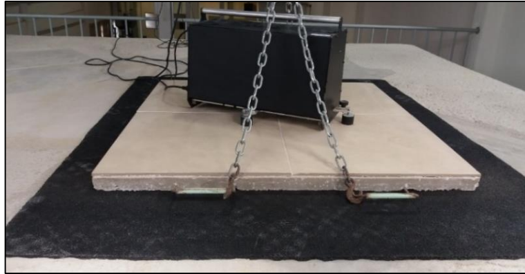
Figura 45 - Borracha reciclada ondulada sob amostra de contrapiso.
