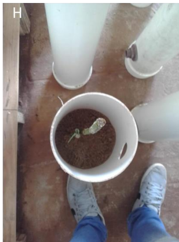
Disposição do filtro após o preenchimento
