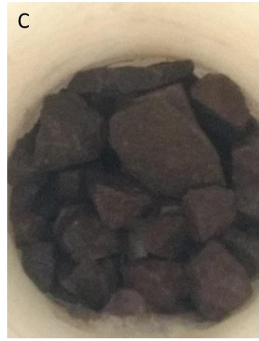
Preenchimento inicial com brita tipo 4
