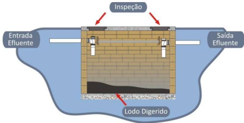
Figura 3.1 - Representação esquemática do funcionamento de um tanque séptico.
