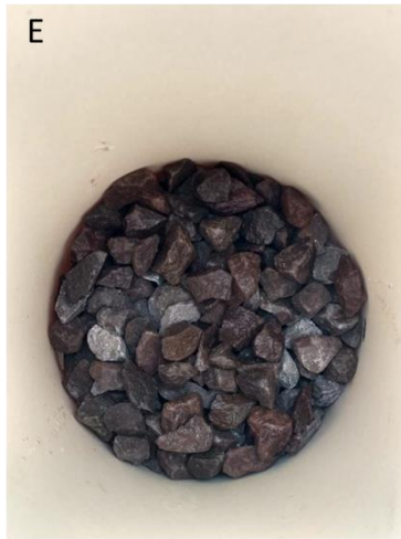
Preenchimento com brita tipo 1
