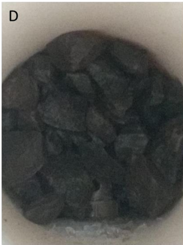
Preenchimento com brita tipo 2
