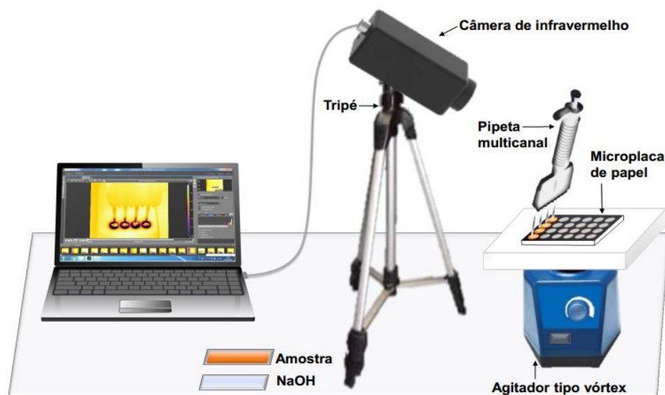
Figura 5. Arranjo experimental utilizado para análise por TIE empregando dispositivo de papel.
