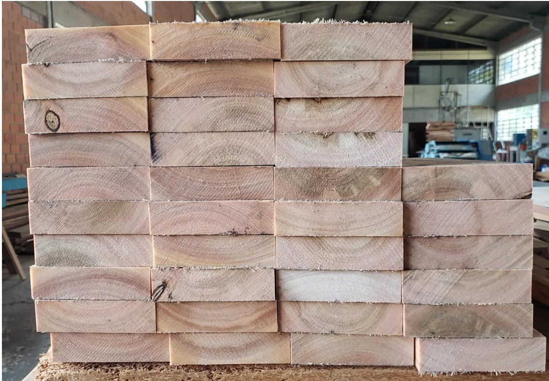
Figura 9 - Tábuas após desdobro.
