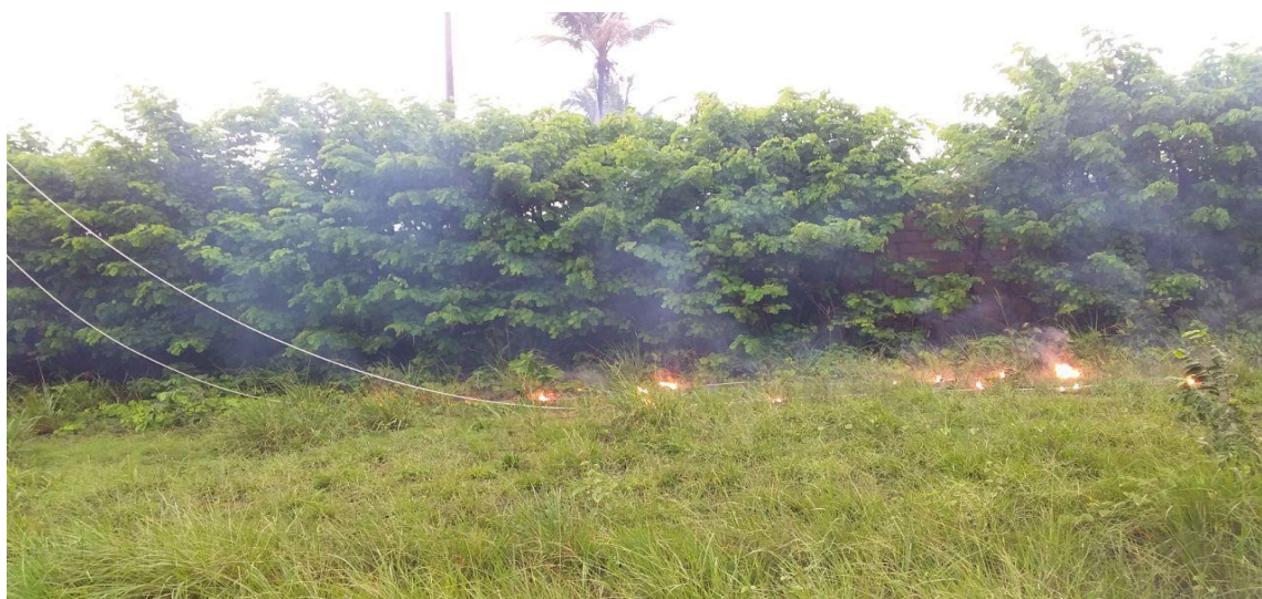
Figura 2.2 – Ocorrência de FAI com geração de arco elétrico.
