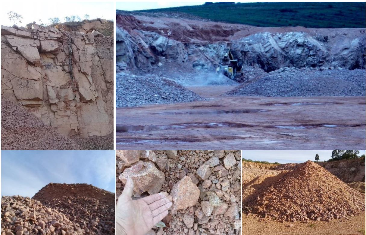
(a) Maciço rochoso utilizado na produção de agregado; (b) processo de britagem; (c) material britado; (d) detalhe da dimensão das partículas do agregado britado e (e) agregado misturado com solo pronto para comercialização.
