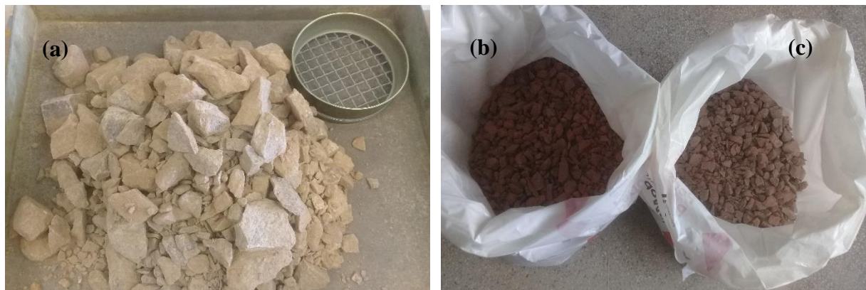
(a) graduação do agregado proveniente da jazida; (b) material passante na peneira \frac{3}{4} " oriundo da jazida - BJ (c) agregado passante na peneira \frac{3}{4} " re-britado em laboratório - BL.
