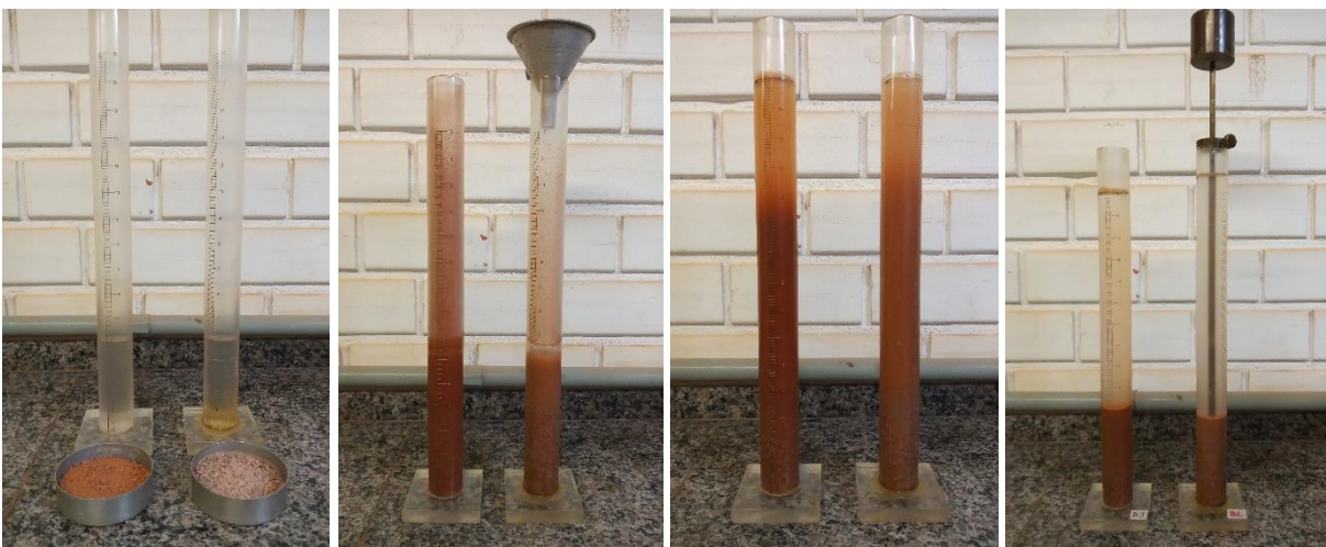
(a) amostra seca, preparada para ensaio (110g); (b) inserção do material no interior da proveta; (c) provetas pós agitação, complementadas até o nível superior, aguardando transcorrer o tempo para leitura; (d) leitura do agregado depositado por sedimentação.
