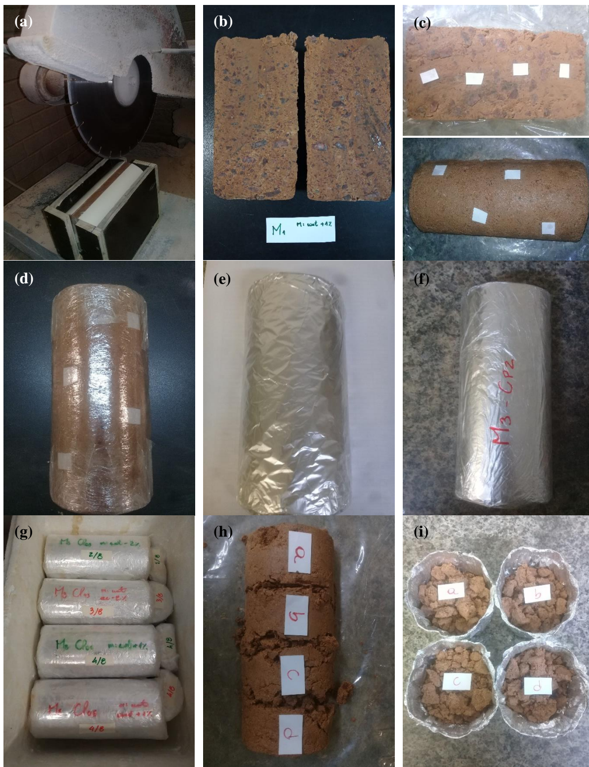
(a) corte do corpo de prova; (b) corpo de prova cortado no sentido longitudinal; (c) inserção dos papéis filtro nas faces interna e externa; (d) primeira camada de filme de PVC; (e) camada de papel aluminizado; (f) segunda camada de PVC e proteção com saco plástico; (g) armazenamento para equalização da umidade; (h) amostras para determinação da umidade pré sucção; (i) amostras para determinação da umidade após secagem em estufa.
