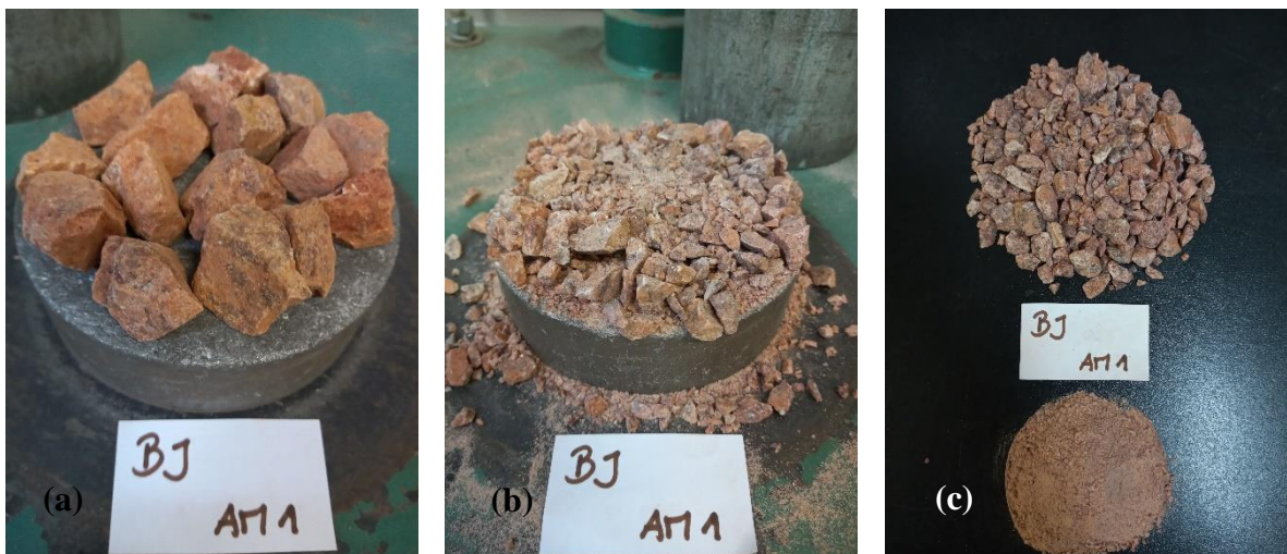
(a) partículas posicionadas antes do choque; (b) material após ação dos 10 golpes; (c) material após peneiramento na abertura 1,7mm.
