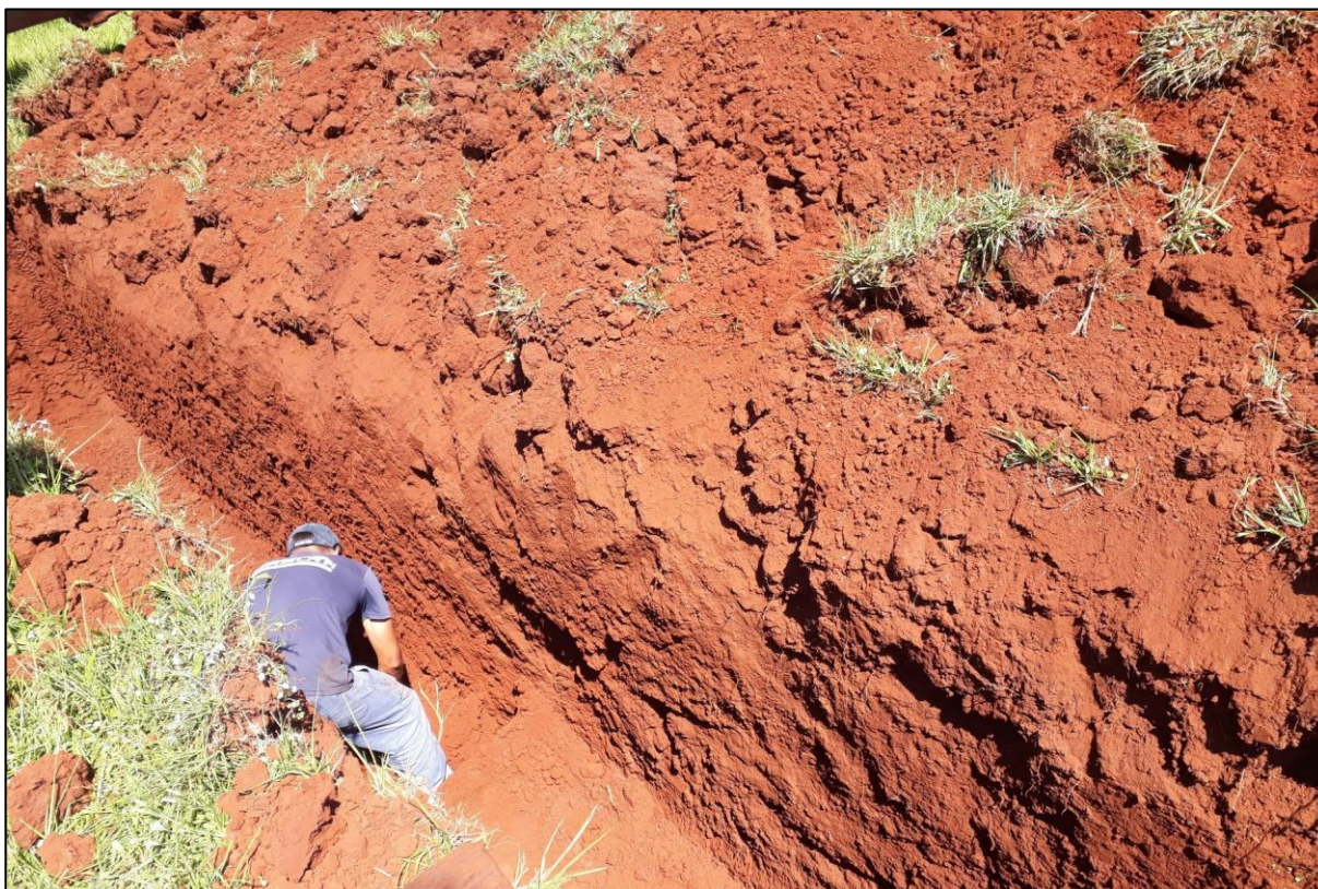
Figura 3.4- Visualização do perfil de solo mediante a abertura de uma trincheira.
