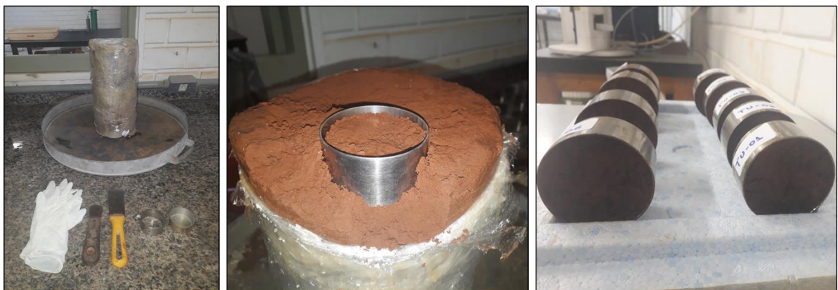
Figura 4.8- Procedimento para a talhagem dos corpos de prova das amostras indeformadas.
