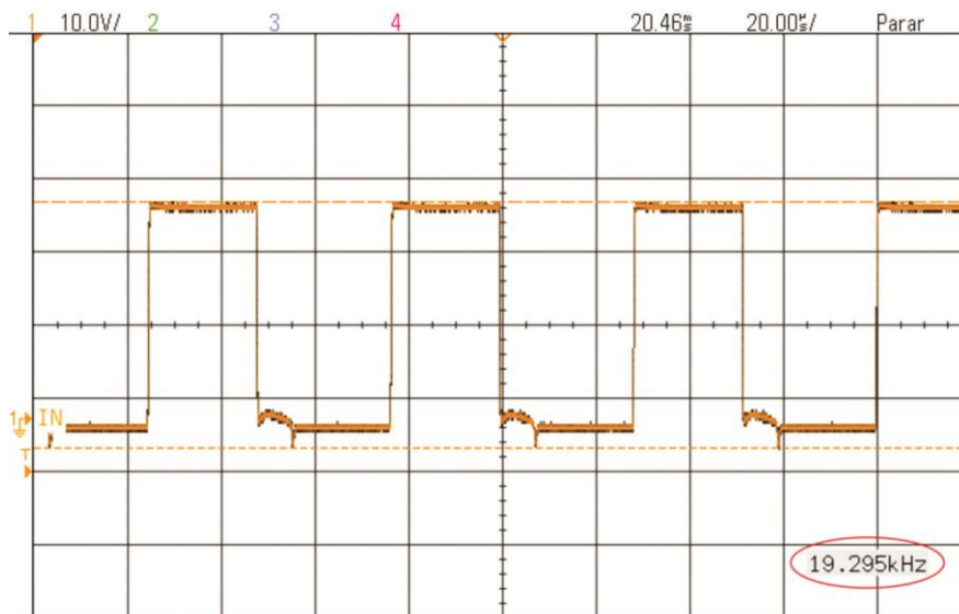
Figura 61: Sinal de gate-source aplicado à chave S do conversor ( v_{GS} ) para a frequência de chaveamento de 19,295 kHz.
